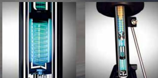
路面の大きな凹凸には、油圧式クッションがサスペンションの動きを制御し、安定した走行を保ちます。
