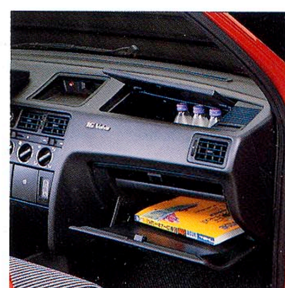
ダッシュボードの上面と正面に設置されたダブルグローブボックス
