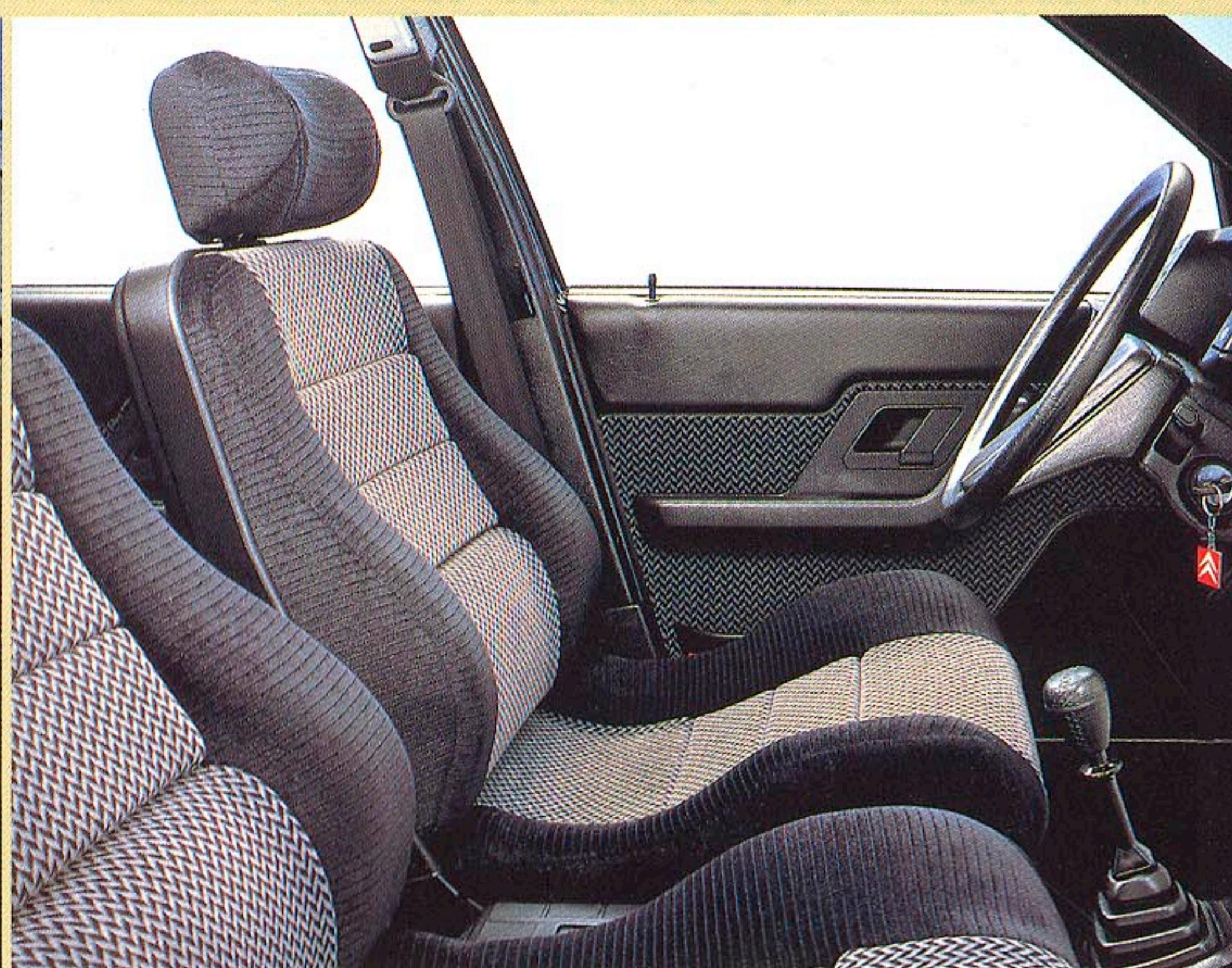
GTi、GTi16Vには、スポーツタイプのシートを採用し、コーナリング時のより確実なサポート性を確保。ブラックとグレーのツートーンを基調にまとめられています。(GTi16Vはランバーサポート調整機構付)
