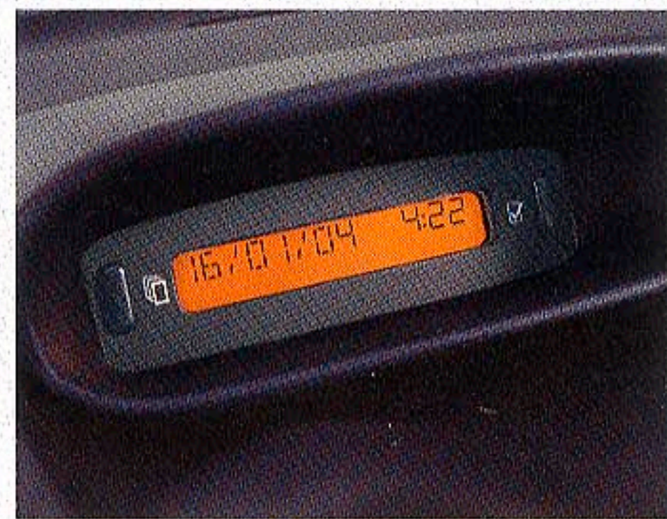
マルチファンクションディスプレイ/ドライブコンピューター 日付・時計・外気温などをマルチファンクションディスプレイに、走行距離・平均燃料消費量・平均速度など車の様々な情報をドライブコンピューター（インストールパネル）に表示します。
