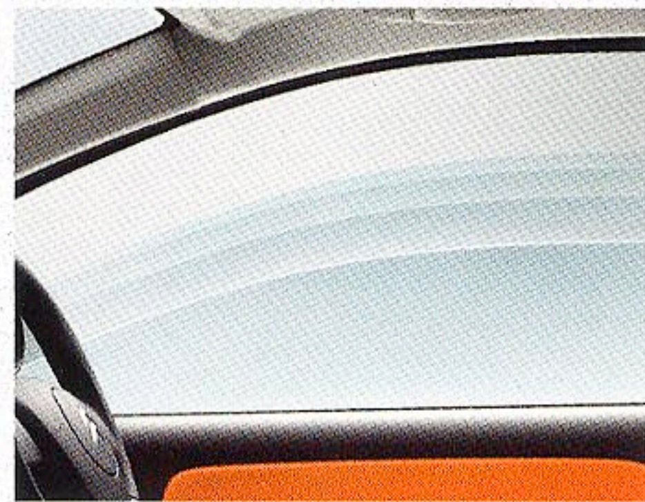
パワーウィンドウ ワンタッチで開閉できるパワーウィンドウ。閉める際、身体などの挟み込みを感知すると自動的に作動を停止し、開いた状態に戻す挟み込み防止機構付です。
