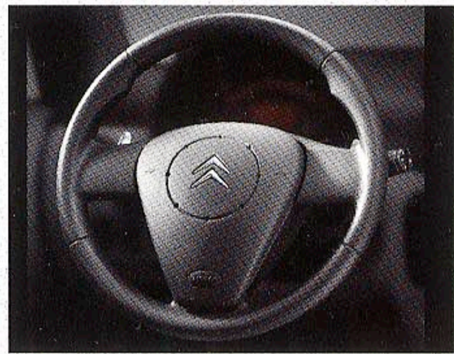
チルト/テレスコピックステアリング ステアリングの位置は、上下・前後に調整可能。最適なドライビング・ポジションを、どなたでも簡単につくれます。
