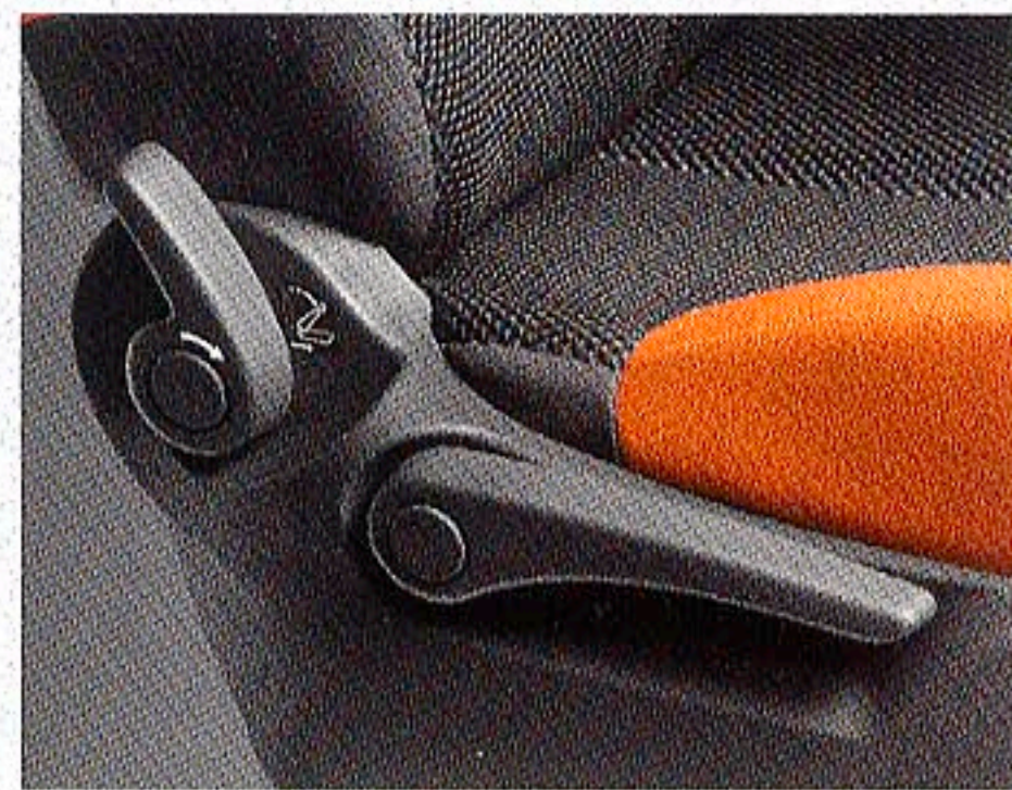
シートハイトアジャスター（運転席） 座る人の体型や好みに合わせて、最適なドライブポジションに調節可能。メモリー機構付ウォークインなので、リアへの乗り降りもスムーズに行えます。
