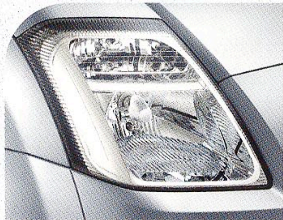
オートヘッドライト 車外の照度を感じてヘッドライトを自動的に点灯・消灯します。
