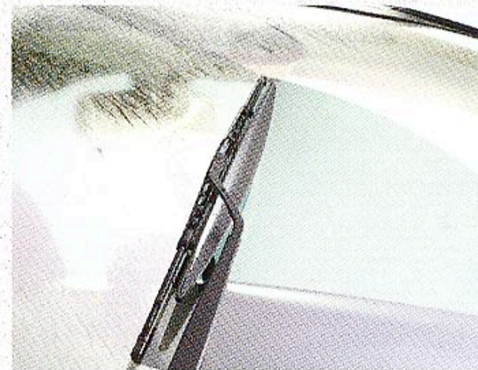
雨滴感知式オートワイパー 水滴を感知すると、自動的にワイパーが作動。また、雨の量やスピードの変化に応じてワイパースピードも自動調節します。
