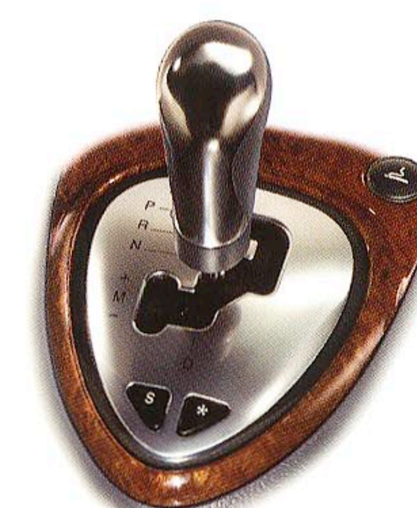
シーケンシャルモード付 3モード電子制御4速オートマチックトランスミッション
