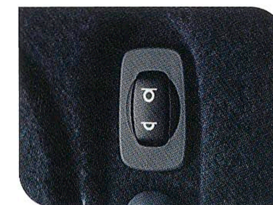
ラゲッジルームハイトコントロールスイッチ 重い荷物の積み降ろしなどに便利。ラゲッジルームからでも車高の調節ができます。 * C5 ブレーク 2.0 C5 ブレーク V6 エクスクルーシブ
