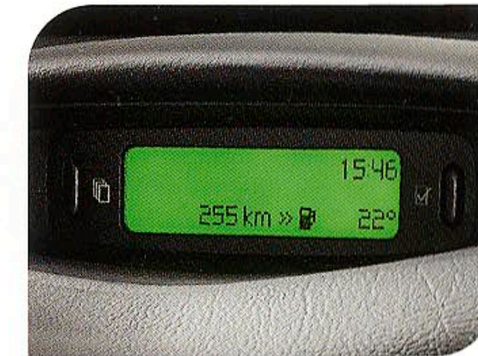
マルチファンクションディスプレイ 日付・時計・外気温のほか、オーディオ、ドライブコンピューターをはじめ、車両の様々な情報を集中表示します。
