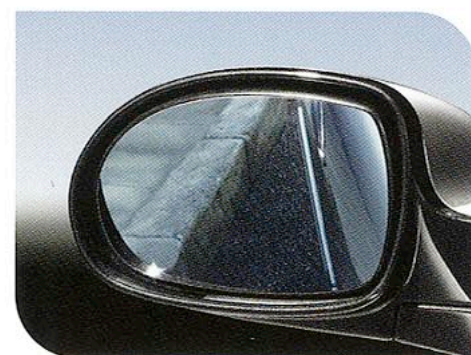
オートマチックバックモードドアミラー ギアをリバースにすると助手席側ドアミラーが下向きになり、後方下部の視界を確保します。
