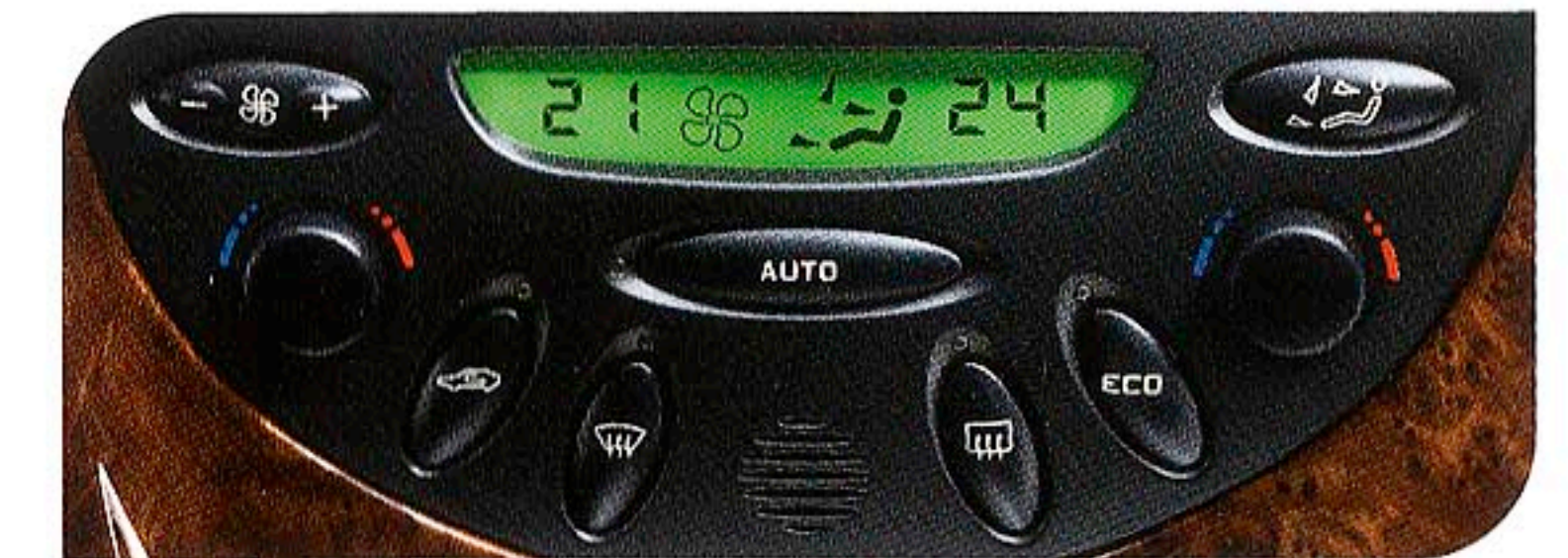
花粉フィルター付オートエアコン 好みの温度を設定すると、温度・風量・吹出し口を自動制御。運転席側/助手席側で独立して温度設定が可能です。
