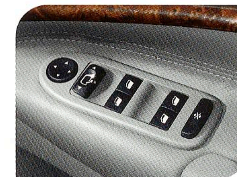
パワーウインドウ フロント/リア全席に装備。ワンタッチ式挟み込み防止機構付です。
