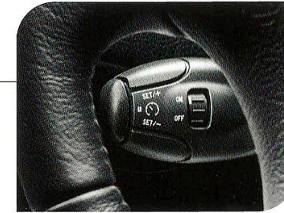
クルーズコントロール 設定した車速を維持し、長時間におよぶ高速走行の疲労を軽減します。 * C5 V6 エクスクルーシブ C5 ブレーク V6 エクスクルーシブ
