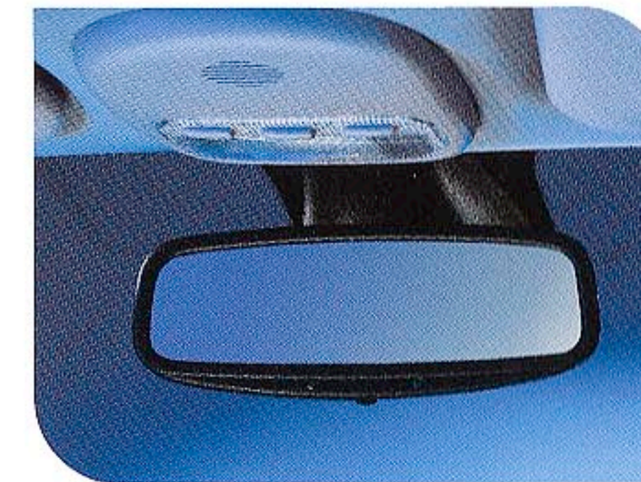
オートディミングミラー 後続車のヘッドライトを感知するとミラーが自動的に反射を減少させます。
