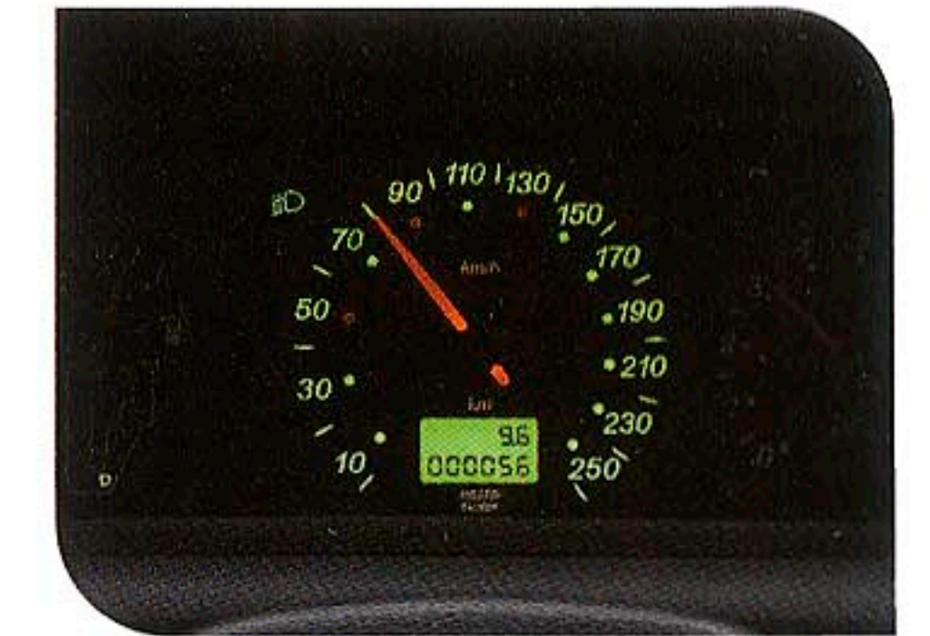
ブラックパネルファンクション 夜間走行時、運転に必要な最小限の情報だけを表示し、ドライバーのストレスを軽減します。
