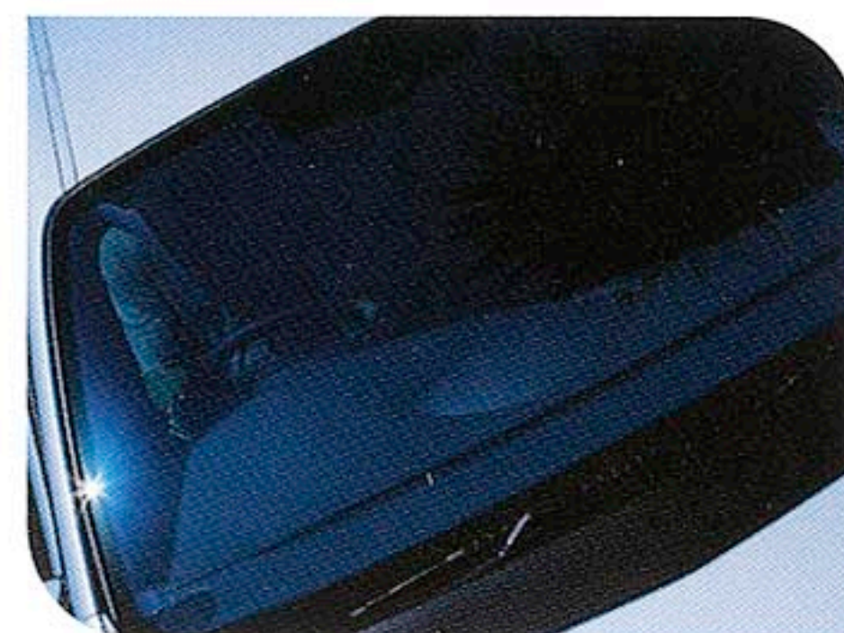
遮熱フロントウインドウ 太陽光の熱線を効果的に遮断し、室内の快適性を高めます。
