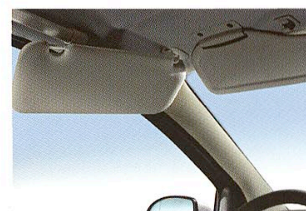
2方向からの日差しを同時に遮ることができる運転席／助手席2フラップサンバイザー(バニティミラー/照明付)
