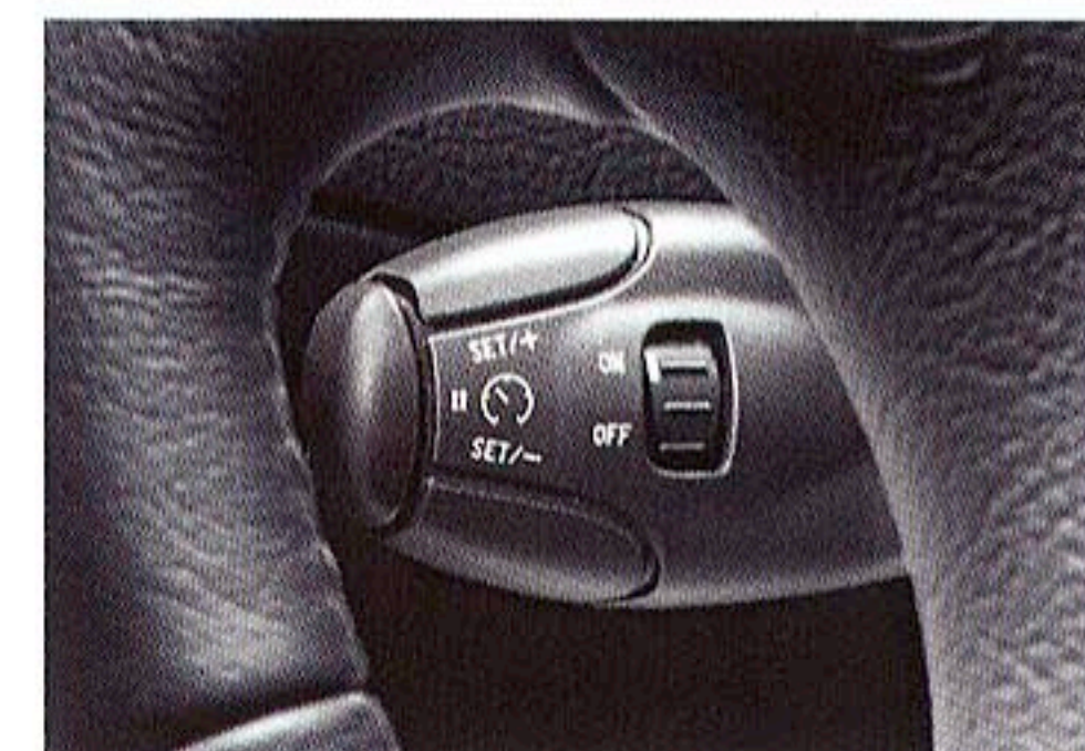
設定した車速を維持し、長時間の高速走行の疲労を軽減するクルーズコントロール(V6 エクスクループ)
