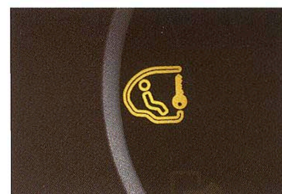
メーターパネル内の表示により、運転席からも確認できるインジケータ付チャイルドロック
