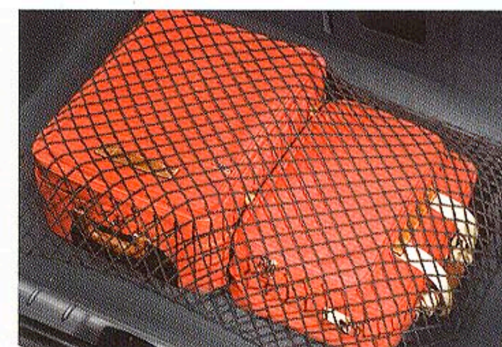
走行中、トランクルーム内の荷物の不要な動きを防止するトランクフロアネット
