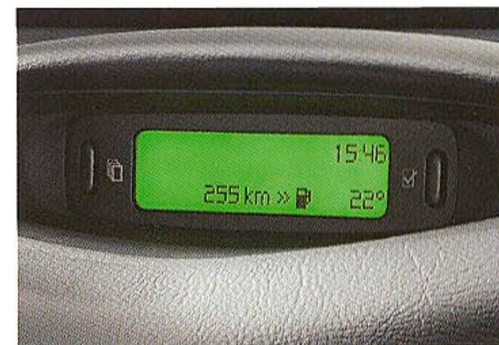
日付・時計・外気温のほか、オーディオ、ドライブコンピュータをはじめ、車両の様々な情報を集中表示するマルチファンクションディスプレイ
