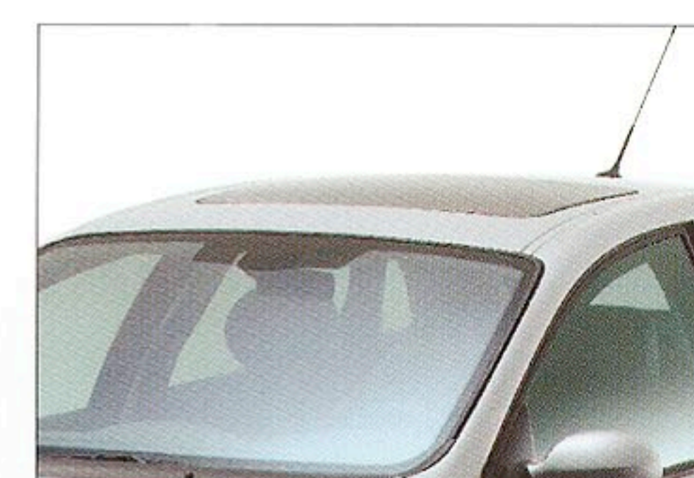
高速走行時や降雨時の自動クローズ機能を備えたチルトアップ機能付電動ガラスサンルーフ(アンチピンチ機構付) *メーカーオプション
