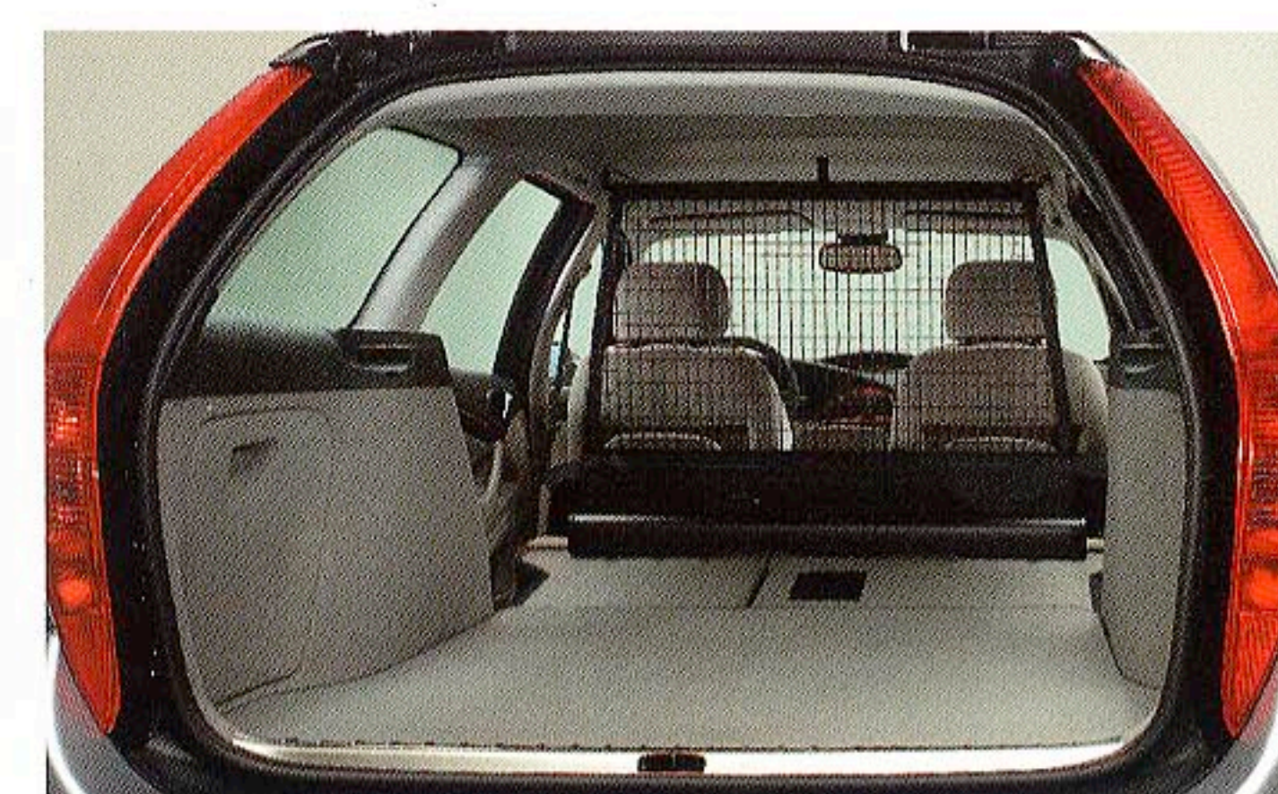
機能的に使えるフラットなラゲッジスペース。積載量は563ℓ。 リアシートを可倒させることで、1,658ℓまで拡大
