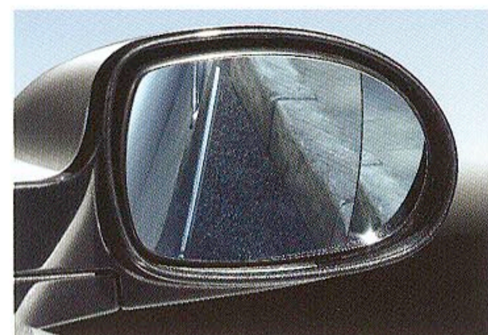
リバースギアで助手席側のミラーが下向きになり後方下部の視界を確保するオートマッチバックモードドアミラー
