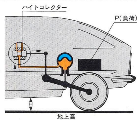
**4** 車高が復元されるとハイトコレクターのリンケージは正常の位置にバルブを戻しサスペンションシリンダーの油圧の回路を閉じます。
