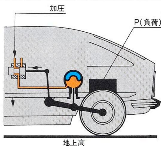
**3** 車体に負荷Pがかかると車体は下り、アームのリンケージが矢印の方向に動いてハイトコレクターのスライドバルブを開け油圧がサスペンションシリンダー内に流入し車高を復元します。
