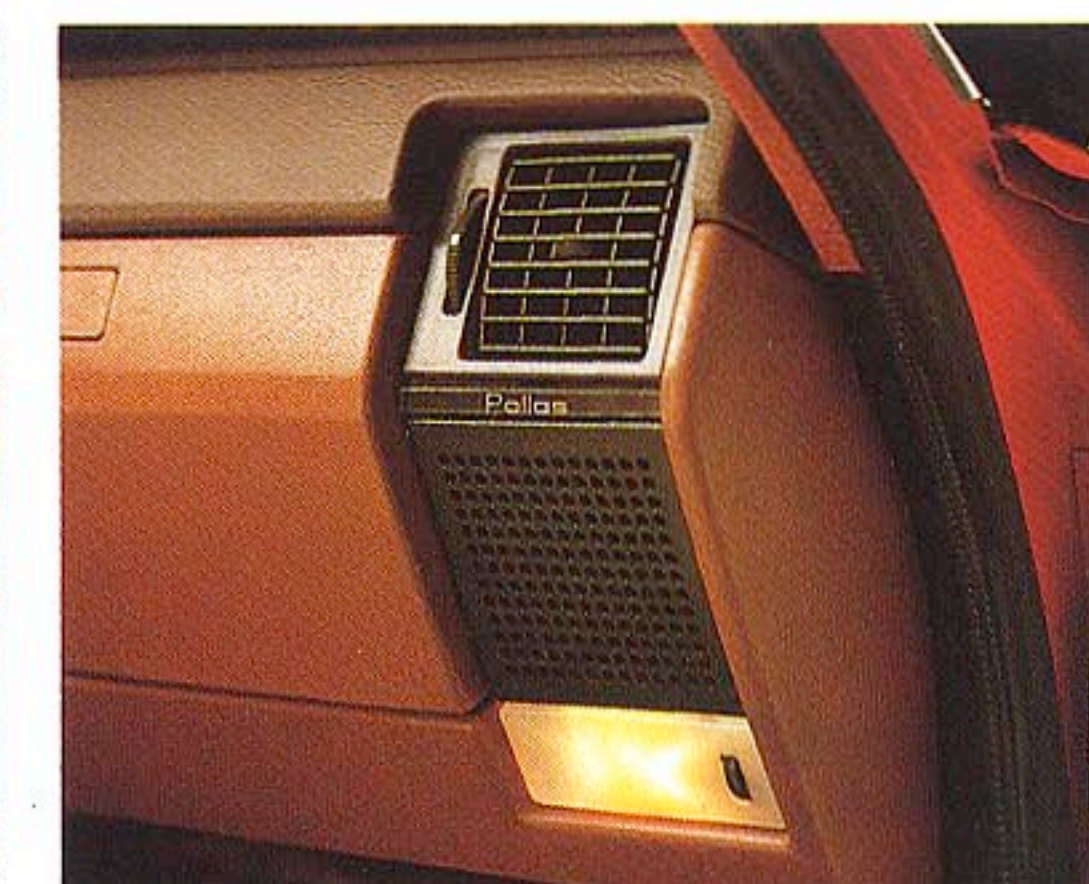
●エアダクト、スピーカー、アシスタントランプ
