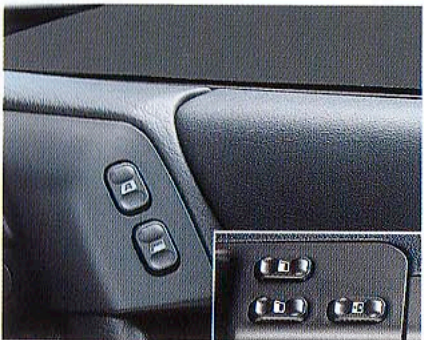
パワーウィンドー 軽い操作でウィンドーを開閉(運転席のみワンタッチ機構付)。リアもフルオープンタイプで、密閉感がありません。
