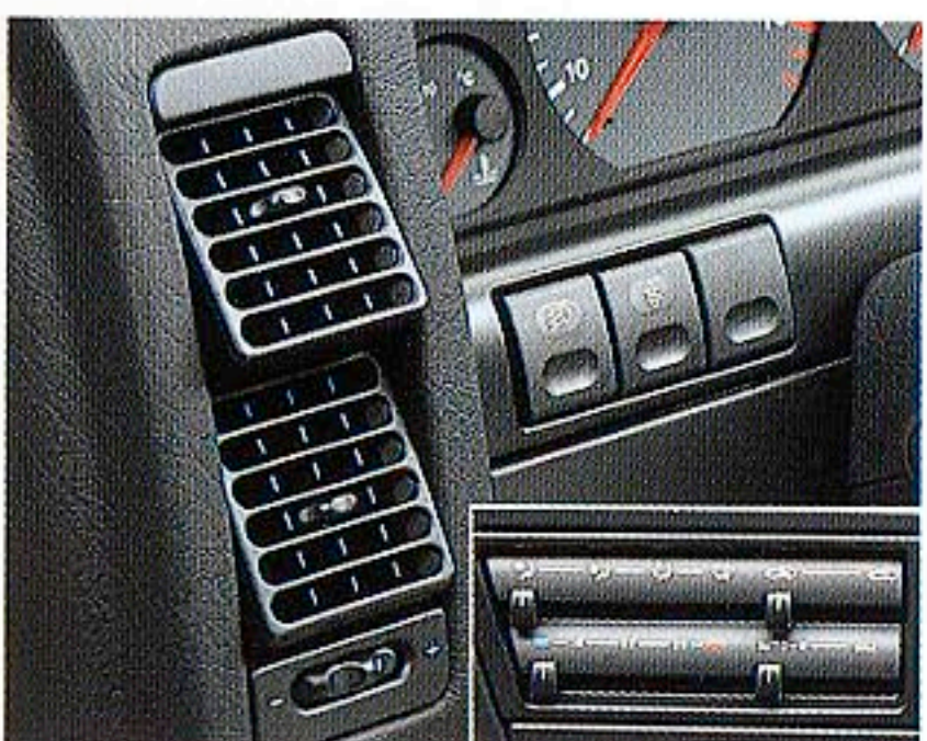
花粉フィルター付オートエアコン(新冷媒R134a 採用) 花粉フィルターの採用で、室内に流入する塵などを遮断。また、大気のオゾン層に影響が少ない新冷媒を採用しました。
