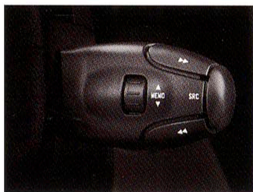
オーディオリモコン (ステアリングコラム) 運転中でもステアリングから手を離すことなく、安全にオーディオ類の操作ができます。
