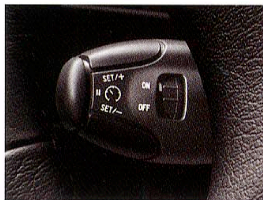
クルーズコントロール 設定した車速を維持し、長時間におよぶ高速走行の疲労を軽減します。
