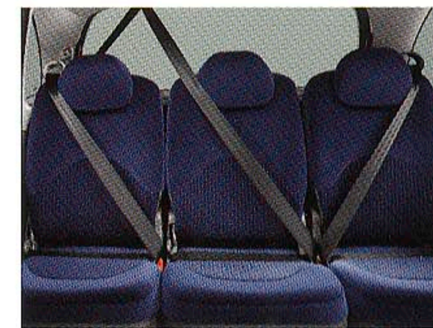
3点式シートベルト 独立したリアシートそれぞれに、安全性に優れた3点式のシートベルトを装備しています。
