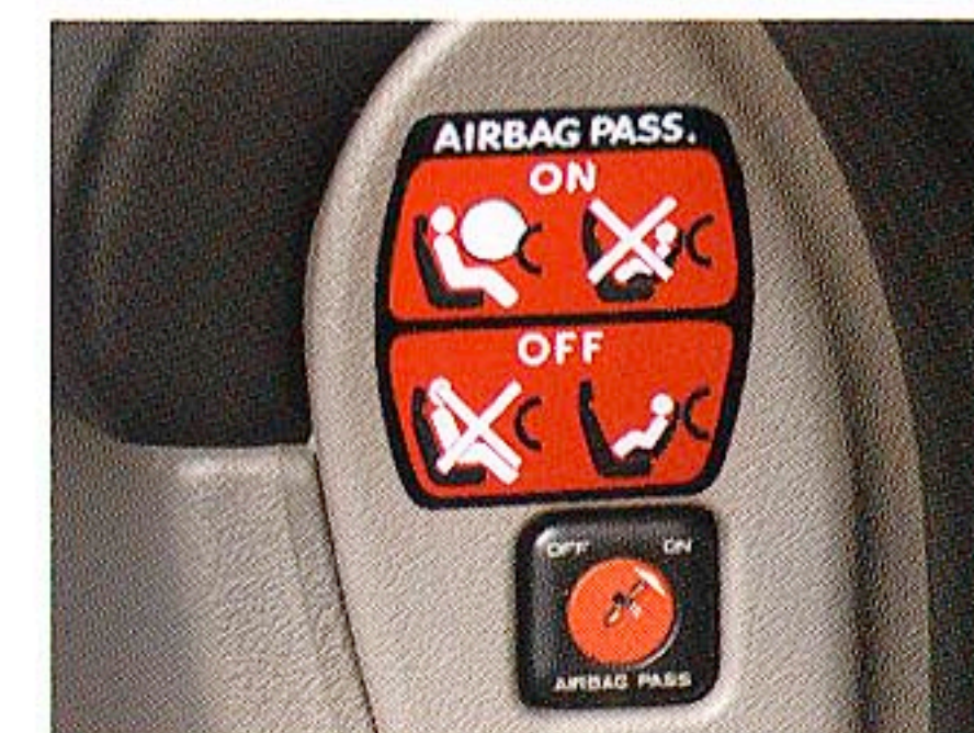
助手席エアバッグキャンセルスイッチ チャイルドシート装着時の安全に配慮し、助手席側のエアバッグはON/OFFの切り替えが可能です。
