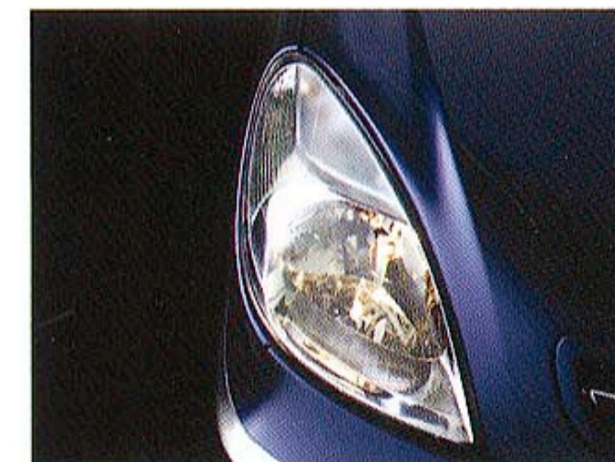
オートヘッドライト 車外の照度を感じてヘッドライトを自動的に点灯・消灯します。
