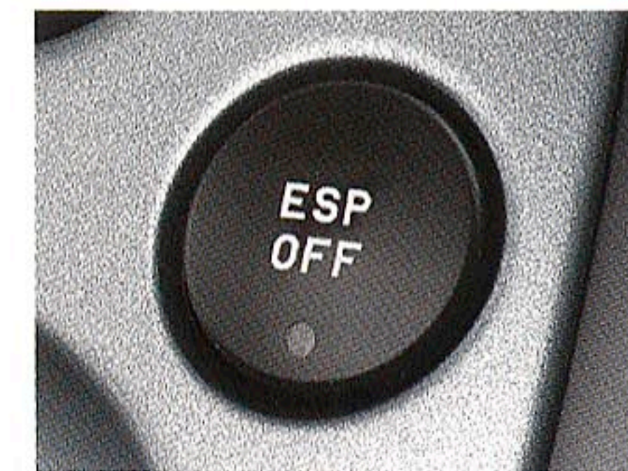
ESP (エレクトロニックスタビリティプログラム) 路面の急激な変化などでタイヤのグリップが失われそうな時、車両のコントロールを補助します。
