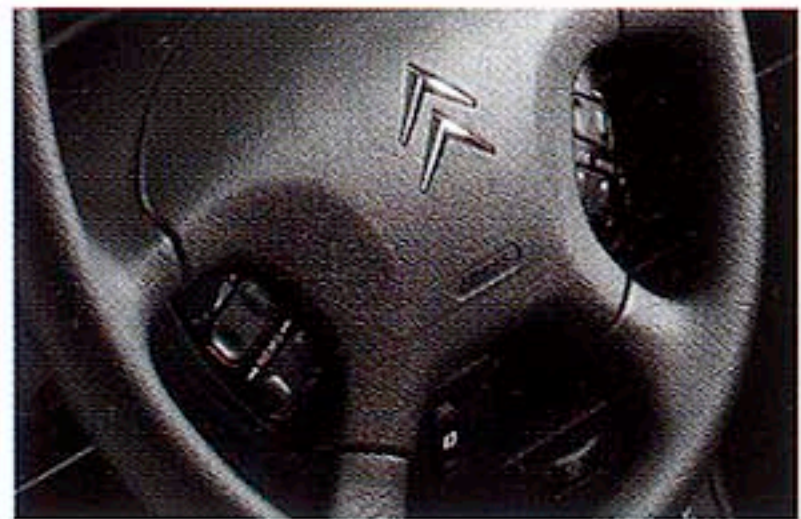
走行中のオーディオ操作の安全性を高めるオーディオ リモコン付4スポークステアリング(2.0、ブレーク2.0)
