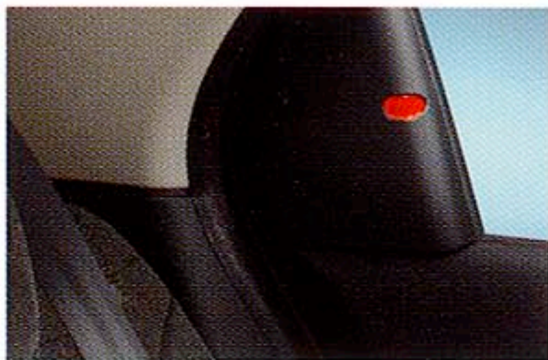
前席からも作動状態が視認できる、 インジケータ付チャイルドブルーフ
