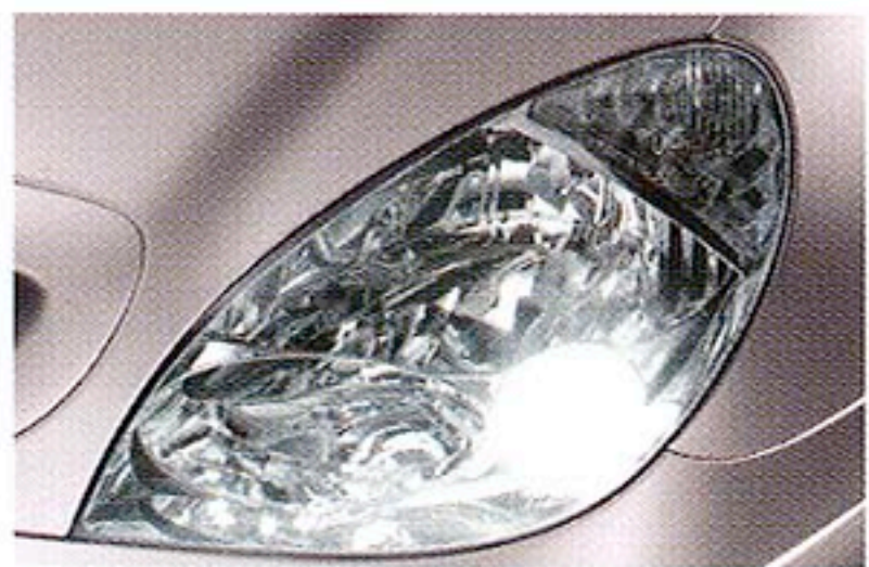
フォグランプ内蔵のヘッドライト。 従来比20%の照度アップを実現
