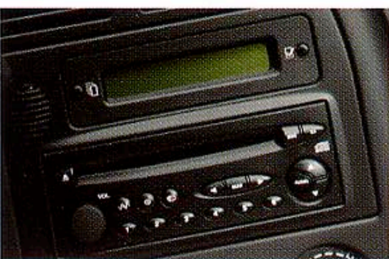
日付・時計・外気温、オーディオ等の状態を 集中表示するマルチファンクションディスプレイ
