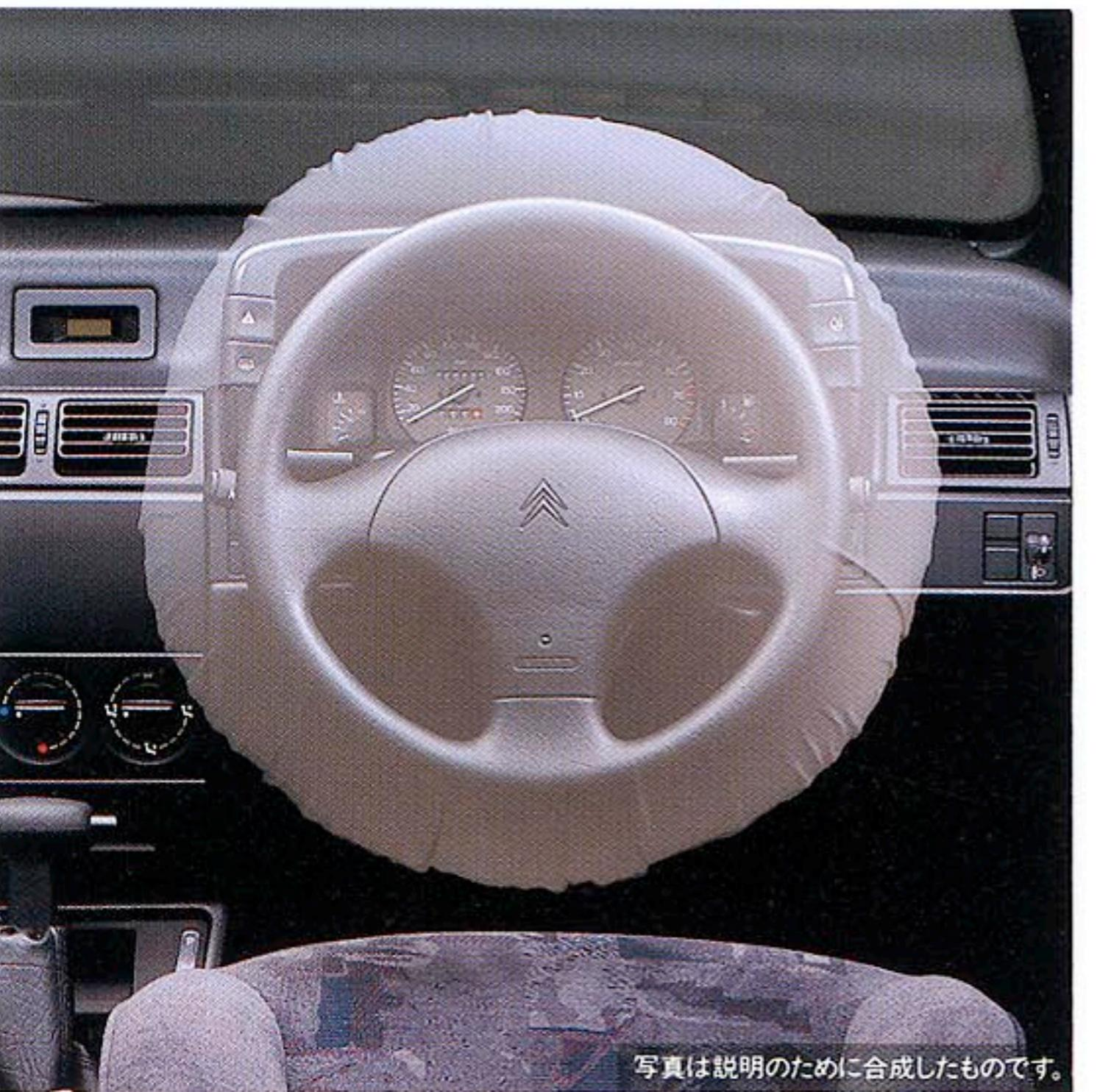
●運転席エアバッグ：前方衝突時、シートベルトの補助拘束システムとして、すぐれた安全性を発揮。衝撃を感じてから膨張・収縮までのプロセスを瞬時に行います。
