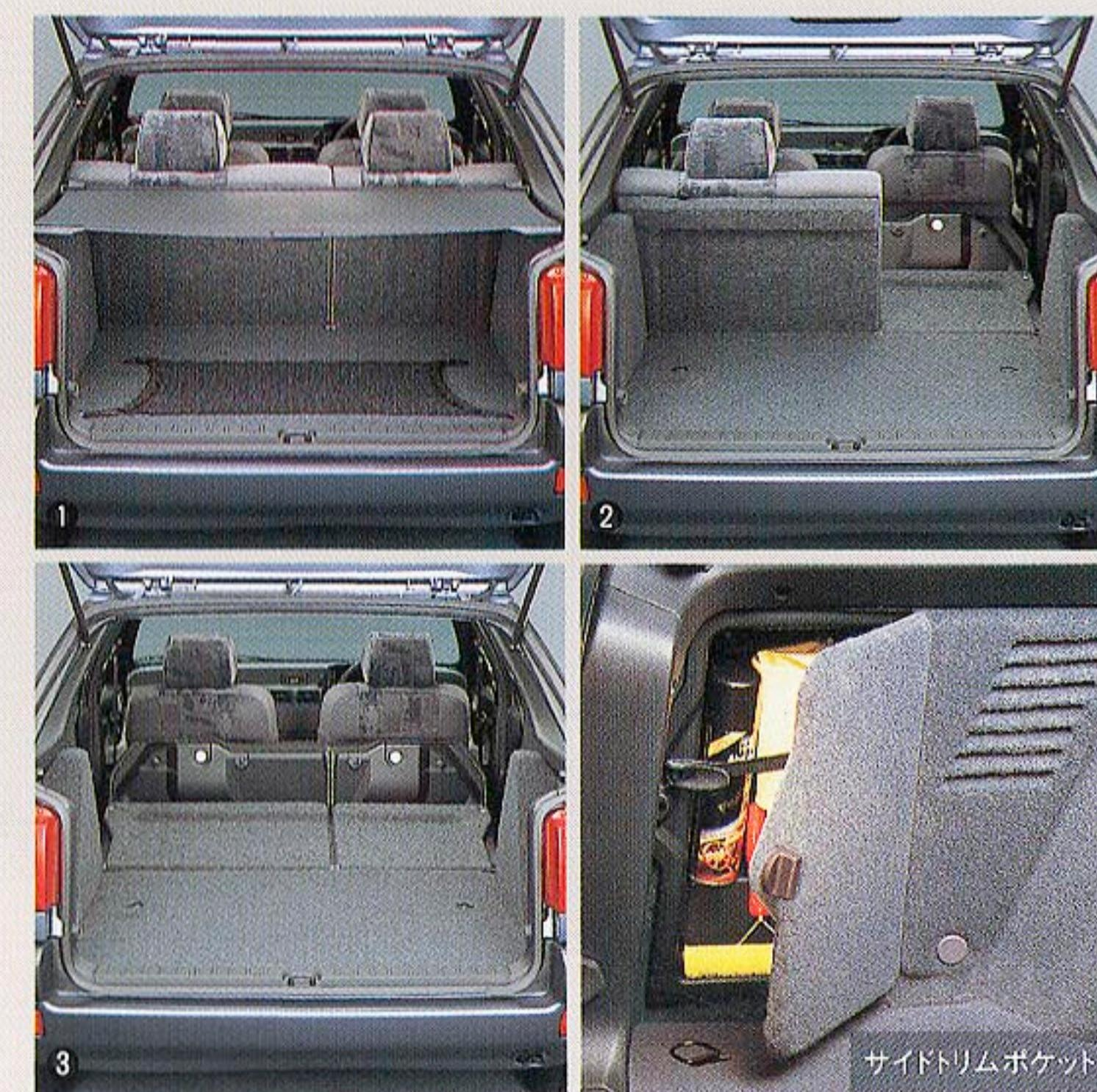
●ブレーク・ユーティリティ(BREAK)：CLUBをベースに全長を190mmサイズアップし、広々とした荷室を確保。荷室容量(DIN方式)は、通常時の488lからダブルフォールディングで1580lまで拡大します。また、ダブルフォールディングしたリアシート面を外せば、フロントシートのスライドやリクリニングを行うことができます。
