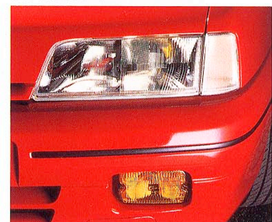
コンプレックスサーフェイスハロゲンヘッドランプとエアダム一体式のフォグランプ
