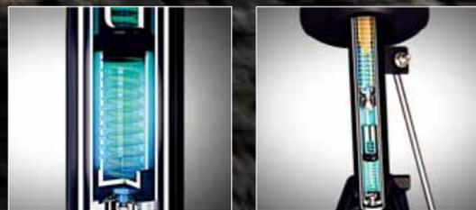
路面の大きな凹凸には、油圧式クッションがサスペンションの動きを制御し、安定した走行を保ちます。
