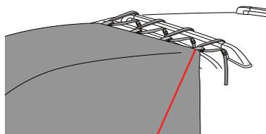
固定ベルトで車体と接続。ベルト部はコネクションカバーで覆われます。
