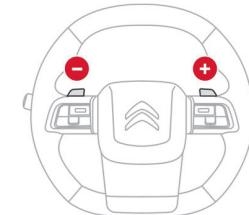
ステアリングの裏側にパドルスイッチがあります。シフトポジションがDまたはMのとき、右側(+)のスイッチでシフトアップ、左側(-)のスイッチでシフトダウンします。
