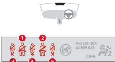
インストルメントパネルとシートベルト着用／非着用ディスプレイの警告灯が点灯または点滅して、シートベルトの着用状況を表示します。
