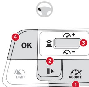
アクティブクルーズコントロールは、ステアリングスイッチのボタンを使用して設定します。
