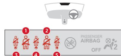
インストルメントパネルとシートベルト着用／非着用ディスプレイの警告灯が点灯または点滅して、シートベルトの着用状況を表示します。
