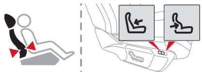
スイッチを押してランバーサポートの張り出しを調整します。
