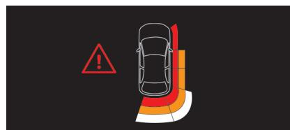
フロント／サイド／バックソナーは、警告音と表示の色で運転者に車両と障害物とのおおよその距離をお知らせします。障害物に接近すると、警告音の頻度が上がり、およそ30cm 以内に接近すると連続した警告音に変わります。
