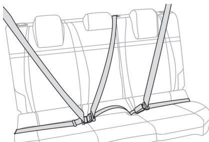
リアシートベルトは3点式で、両サイドのシートのシートベルトはフォースリミッター付きシートベルトプリテンションシステムです。
