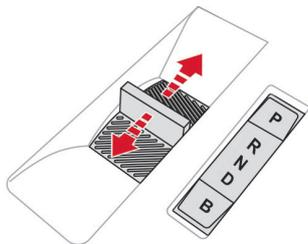
ドライブセレクターを前後に動かす、またはドライブセレクターの右側にあるスイッチを押してシフトポジションを選択します。選択されているシフトポジションは、インストルメントパネルおよびドライブセレクターの右側にあるインジケーターに表示されます。**ENGINE START/STOP** スイッチをオフにしてしばらくの間、インジケーターにシフトポジションが表示されます。
