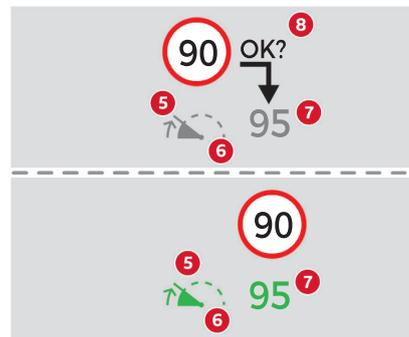
スピードリミッターの情報は、インストルメントパネル内のディスプレイに表示されます。
