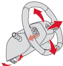
1. ロックレバーを手前に引き、ステアリングのロックを解除します。
