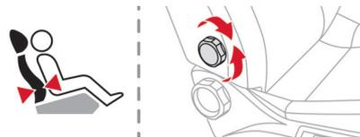
ダイヤルを回してランバーサポートを調整します。
