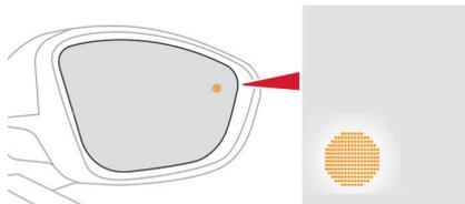
他車を検知した側のドアミラーに警告灯が点灯します。
