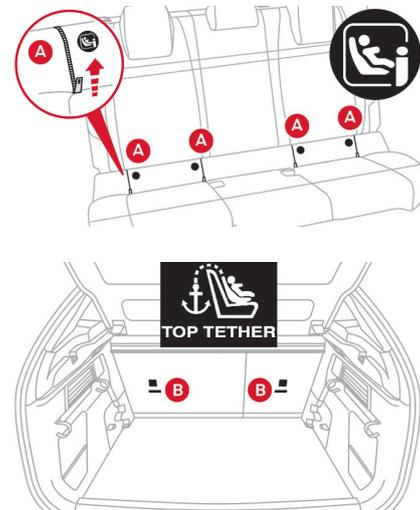
シートのバックレストとシートクッションの間に2つの金具 **A** があります。金具 **A** にジッパーが装備されている場合は、ジッパーを開けて使用してください。
