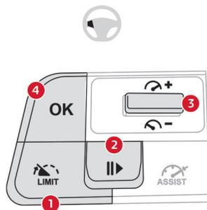
スピードリミッターは、ステアリングスイッチのボタンを使用して設定します。
