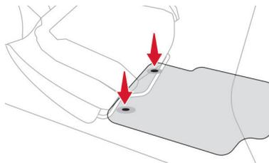
取り付けるときは、フロアマットを正しい位置に合わせ、クリップで留めてください。フロアマットがしっかり固定されていることを確認してください。
