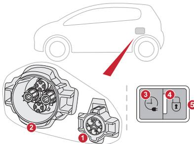
リチウムイオンバッテリーを充電するときは、車載充電ケーブルの充電コネクタ、または充電器に付属の充電ケーブルの充電コネクタを車両の充電ポートに接続します。
