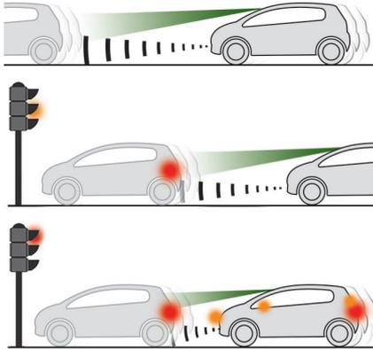
ディスタンスアラートの警告が表示されたあと運転者が衝突回避動作を取らなかったとき、自動ブレーキが作動し、衝突回避を支援したり、衝突時の速度を低減します。
