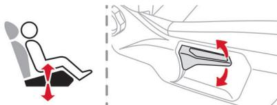
レバーを上下に動かして高さを調整します。
