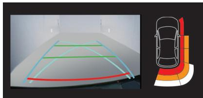
バックカメラの映像には距離や車幅の目安となるラインなどが表示されます。
