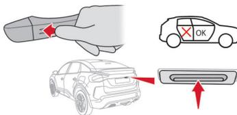
スマートキーを携帯してゾーンCに入ります。または、スマートキーを携帯して運転席ドアのドアハンドルのスイッチまたはテールゲートのスイッチを押します。すべてのドアおよびテールゲートが解錠されます。
