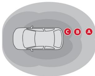
スマートキーを携帯して車両の検知エリアに入る／出ると車の解錠／施錠が自動的に行われます。
