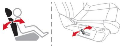
スイッチを前後に倒して背もたれの角度を調整します。
