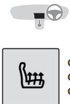
シートヒーターは運転席と助手席に装備され、外気温が20℃以下で、EVシステムが始動している状態のとき、別々に作動させることができます。ダッシュボードのスイッチを押して設定した温度に自動調整されます。
