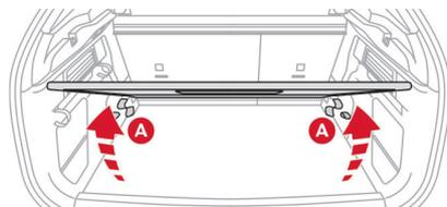
2ポジションラゲッジフロアボードを持ち上げた位置で固定するには、2ポジションラゲッジフロアボードを持ち上げ、**A**部に差し込みます。
