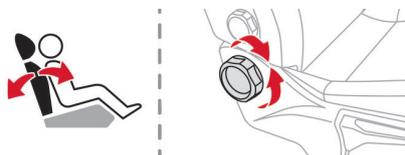
ダイヤルを回して背もたれの角度を調整します。
