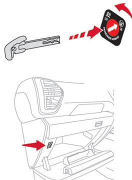
チャイルドシートを進行方向とは逆向きに助手席へ取り付けるときは、助手席のエアバッグが作動しないようにします。これはエアバッグが作動してふくらんだときの衝撃からお子さまを守るためです。
