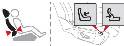
スイッチを押してランバーサポートの張り出しを調整します。
