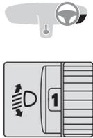
ラゲッジルームに重量物を積んでヘッドランプが上向きになったときは、対向車に眩しくないよう、ダイヤルの数値を上げて照射角度を下向きにしてください。
