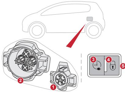
充電ポートリッドの後ろ側を押し、充電ポートリッドを開きます。3kW / 6kW 普通充電ポート①や急速充電ポート②から充電コネクタをはさずときは、充電コネクタのリリースボタンを押しながら（ロック解除灯④が赤色に点灯します）引き抜きます。充電インジケータ⑤の点灯／点滅で充電の状態を確認できます。あらかじめ設定した充電予約をセツするには、充電予約ボタン③を押します。
