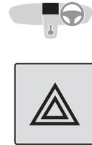
ENGINE START/STOP スイッチのポジションに関係なくスイッチを押すと作動します。他車に緊急停車中であることを示します。
