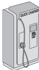
外出先などに設置されたCHAdeMO（チャデモ）規格に準拠した急速充電器（定格出力20～50kW）と急速充電器に付属の充電ケーブルで行う充電方法です。普通充電器よりも短時間で充電することができます。充電が完了するまでの時間の目安は、約50分です（定格出力50kWの場合。満充電量の約80%充電にかかる時間の目安）。
