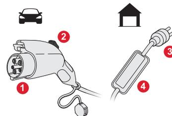
車両に付属の充電ケーブル（コントロールユニット付き）は、EV車専用のコンセントで3kW普通充電するときを使用します。
