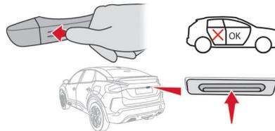
プロキシミティキーレスエントリー機能の自動施錠／解錠機能がオンの場合は、スマートキーを携帯してゾーン C に入ります。または、車両周辺の検知エリアにスマートキーがあるときに運転席ドアのドアハンドルのスイッチを押すか、テールゲートのスイッチを押します。すべてのドアおよびテールゲートが解錠されます。テールゲートのスイッチを押した場合は、テールゲートが少し開きます。
