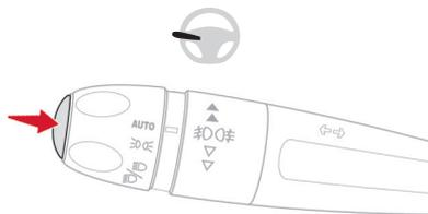
ライトスイッチレバー先端のスイッチを押すと、インストルメントパネルのディスプレイゾーンに表示される表示モードが切り替わります。
