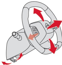
ロックレバーを手前に引くと、ステアリングのロックが解除されます。ステアリングホイールの高さや奥行きを調整し、ロックレバーを押し下げてロックしてください。ステアリングがしっかり固定されていることを確かめてください。
