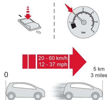
6. スイッチが**0**になっていることを確認してから、コンプレッサーの電源コードを12V電源ソケットに差し込みます。
