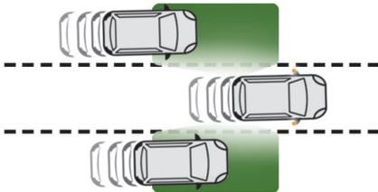
ブラインドスポットモニターは、ドアミラーでの確認が困難な範囲に他車が進入した際に、その存在を検知して運転者に警告するシステムです。
