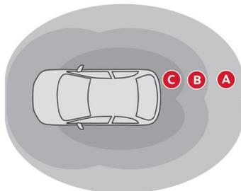
プロキシミティキーレスエントリー機能の自動施錠／解錠機能の検知エリアはゾーンA\*、ゾーンB、ゾーンCに分けられます。
