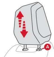
ヘッドレストの上端と乗員の頭の上が揃うように、ヘッドレストを上下に動かして調整します。
