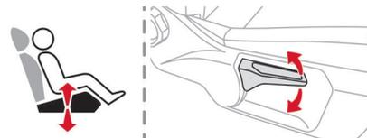
レバーを上下に動かして高さを調整します。
