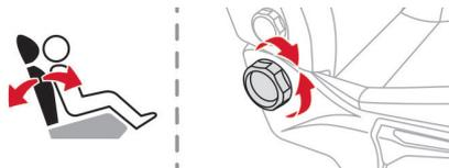
ダイヤルを回して背もたれの角度を調整します。
