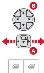
調整するミラーに合わせて、スイッチ **A** を左側または右側に動かします。ミラーは上下左右に角度が変えられます。スイッチ **B** の動かしたい側のボタンを押します。調整が終わったら、スイッチ **A** を中央の位置に戻します。
