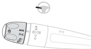
周囲が暗くなったりウィンドウワイパーが作動すると、自動的にポジションランプやヘッドランプが点灯します。周囲が明るくなったりワイパーが停止すると、自動的に消灯します。
