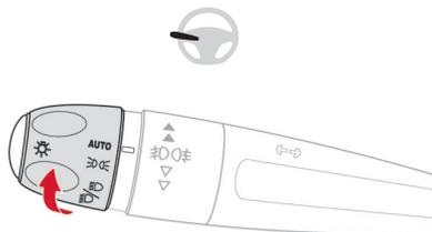
ライトスイッチレバーのリングを回して操作します。
