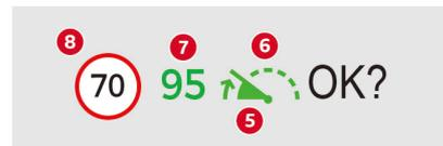
スピードリミッターの情報は、インストルメントパネル内のディスプレイに表示されます。
