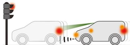
ディスタンスアラートの警告が表示されたあとも運転者が衝突回避動作を取らなかったとき、自動ブレーキが作動し、衝突回避を支援したり、衝突時の速度を低減します。
