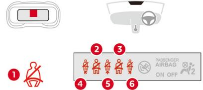
インストルメントパネルの警告灯①とシートベルト着用／非着用ディスプレイの警告灯②から⑥が点灯または点滅して、シートベルトの着用状況を表示します。
