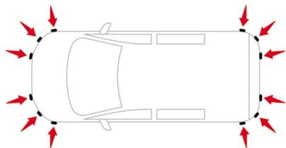
フロント／リアバンパーに埋め込まれたセンサーが障害物（歩行者、車、立木、門など）を検知して、警告音、タッチスクリーンの表示、インストルメントパネルの警告灯で運転者にお知らせします。
