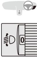
ラゲッジルームに重量物を積んでヘッドランプが上向きになったときは、対向車に眩しくないよう、ダイヤルの数値を上げて照射角度を下向きにしてください。
