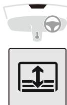
開くときは、ボタンの後ろ側を押し続けます。ボタンから手を離すとサンシェードが停止します。
