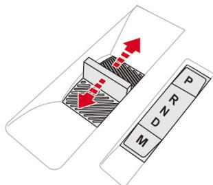
プッシュセレクトターを前後に動かす、またはプッシュセレクトターの右側にあるスイッチを押してシフトポジションを選択します。選択されているシフトポジションは、インストルメントパネルおよびプッシュセレクトターの右側にあるインジケーターに表示されます。**ENGINE START/STOP**スイッチをオフにしてもしばらくの間、インジケーターにシフトポジションが表示されます。
