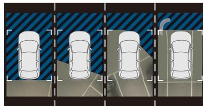
トッリアビジョンは、テールゲートに取り付けられたカメラの映像を合成して車両を上方から見たような映像を表示します。駐車や出庫の際に、車両後方周囲の障害物を確認できます。
