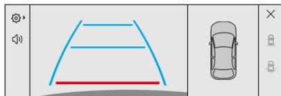
テールゲートに取り付けられたカメラ、およびリアバンパーに埋め込まれたセンサーがタッチスクリーンに車両後方および後方周囲の映像を映し出し、駐車や出庫の際の安全確認を補助します。
