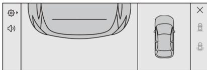
障害物がリアバンパーの後方約30cm（バックビューの赤いライン）に近付くと車両を上から見たような映像がタッチスクリーンに表示されます。
