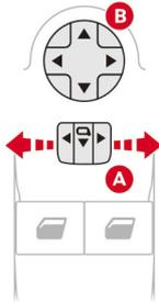
調整するミラーに合わせて、スイッチ **A** を左側または右側に動かします。ミラーは上下左右に角度が変更されます。スイッチ **B** の動かしたい側のボタンを押します。調整が終わったら、スイッチ **A** を中央の位置に戻します。
