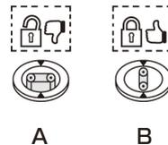
運転席側に取り付けるときは、フロアマットを正しい位置に合わせ、クリップを回転させて固定してください。フロアマットがしっかりと固定されていることを確認してください。
