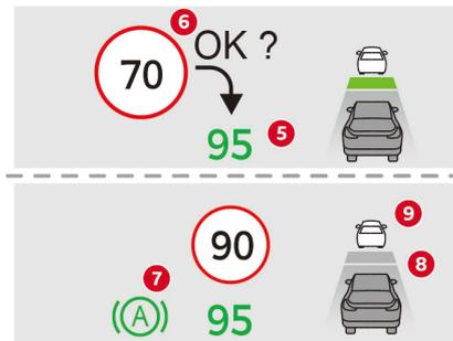
アクティブクルーズコントロールの情報は、インストルメントパネルのディスプレイにミニビューとして表示されます。
