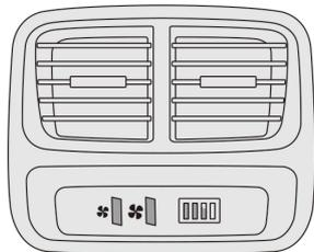
大きい羽根のアイコン側のスイッチを押すと風量が増加します。
