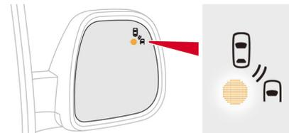
他車を検知した側のドアミラーに警告灯が点灯／点滅します。
