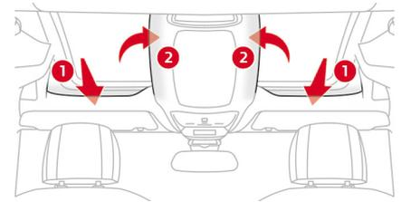
サンバイザー上部①と天井中央部②に小物入れが装備されています。天井中央部②の小物入れの最大荷重量は約6kgです。
