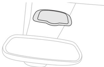
運転中も容易に後部座席の確認ができるよう、チャイルドウォッチミラーがルームミラー上部に装備されています。夜間に後続車のヘッドランプが眩しいときは、台座部分を回転させてミラーの向きを調節することができます。
