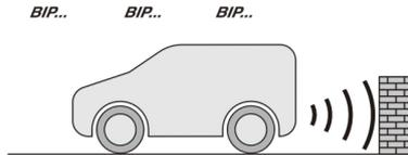
システムは、警告音で障害物とのおおよその距離をお知らせします。障害物に接近すると、警告音の頻度が上がり、およそ30cm以内に接近すると連続した警告音に変わります。
