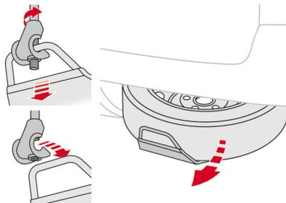
4. キャリアボルトを十分にゆるめたらキャリアをフックからはずし、スペアタイヤを引き出します。
