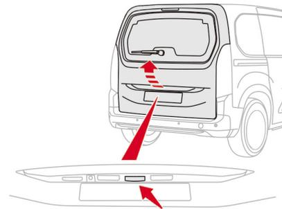
車両周辺の検知エリアにスマートキーがあるときに、テールゲートのスイッチを押すと、すべてのドア、テールゲートおよびリアオープニングガラスハッチが解錠され、テールゲートが少し開きます。そのままテールゲートを持ち上げて開きます。
