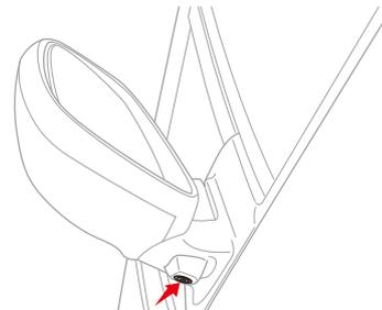
サイドビューカメラが捉えた映像を、バックミラー左部分のカメラモニターに表示することで、運転操作を補助するシステムです。
