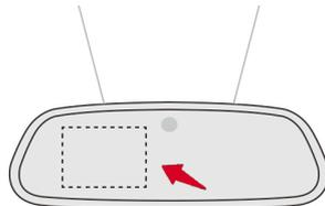
バックミラーの左部分には液晶ディスプレイが内蔵されていて、サイドビューカメラの映像を表示するカメラモニターとなっています。
