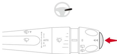
トリップ1 / トリップ2をリセットするときは、ワイパーレバー先端のスイッチを2秒以上押し続けます。リセットは各トリップごとに行うことができます。リセット後しばらくはデータ不足のために正確な値が表示されないことがあります。
