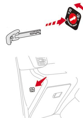
チャイルドシートを後ろ向きに助手席へ取り付けるときは、助手席のエアバッグが作動しないようにします。
