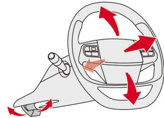
1. ロックレバーを手前に引き、ステアリングのロックを解除します。
