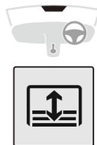
開くときは、ボタンの後ろ側を押し続けます。ボタンから手を離すとサンシェードが停止します。
