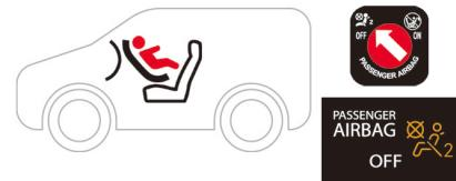
後ろ向きチャイルドシートを助手席に取り付ける際、助手席エアバッグの機能をキャンセルすることが必要です。
