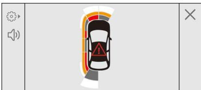
サイドソナーは、フロント／バックソナーが検知した車両前方または後方の障害物の位置を元に、障害物が車両側面に接近したと判断された場合に障害物とのおおよその距離をお知らせします。
