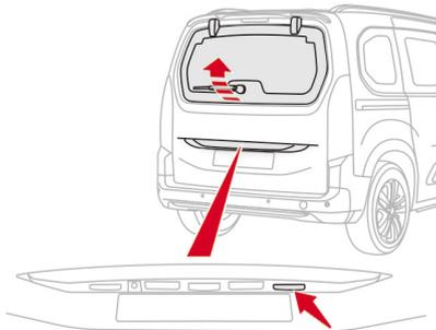
車両周辺の検知エリアにスマートキーがあるときに、テールゲートの右側のスイッチを押すと、すべてのドア、テールゲートおよびリアオープニングガラスハッチが解錠され、リアオープニングガラスハッチが少し開きます。リアワイパーアームの支柱を持ってリアオープニングガラスハッチをゆっくり持ち上げます。
