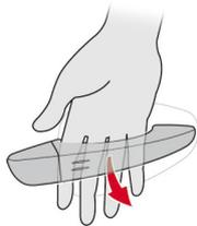
車両周辺の検知エリアにスマートキーがあるときに、前席のドアハンドルに手を通すと、すべてのドア、テールゲートおよびリアオープニングガラスハッチが解錠されます。ドアハンドルをそのまま引くとドアを開けることができます。
