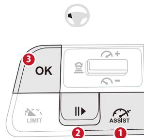
アクティブクルーズコントロール（ストップ&ゴー機能付き）の機能がオンまたは作動中のとき、ステアリングスイッチの**ASSIST**ボタン①を押すと、システムがオンになり、インストルメントパネルの表示灯が点灯します。再度ステアリングスイッチの**ASSIST**ボタン①を押すと、システムがオフになり、インストルメントパネルの表示灯が消灯します。レーンポジショニングアシストがオフになると同時にアクティブクルーズコントロールもオフになります。
