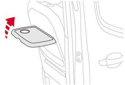
フロントシートのバックレスト背面には、可倒式のテーブルが装備されています。使用するときはテーブルを引き上げます。収納するときは、テーブルを押し下げます。
