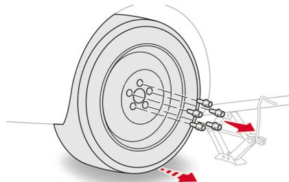
1. スチールホイール装着車は、ホイールキャップリムーバー⑥を使いホイールキャップを取りはずします。アルミホイール装着車は、専用ピンセット⑦を使用して、ボルトカバーをはずします。
