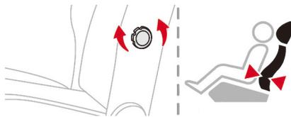
ダイヤルを回してランバーサポートを調整します。
