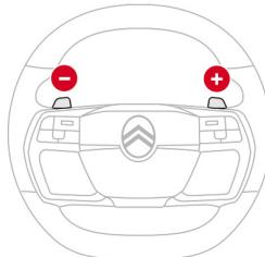
ステアリングの裏側にパドルスイッチがあります。シフトポジションが**D**または**M**のとき、右側（+）のスイッチでシフトアップ、左側（-）のスイッチでシフトダウンします。
