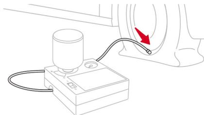
8. スイッチが0になっていることを確認してから、コンプレッサーの電源コードをセンターコンソールの12V電源ソケットに差し込みます。
