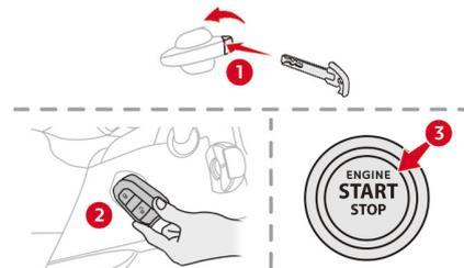
1. 助手席ドアの鍵穴に緊急用キーを差し込み、車両前方に回して解錠します①。
