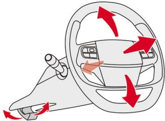
ロックレバーを手前に引くと、ステアリングのロックが解除されます。ステアリングホイールの高さや奥行きを調整し、ロックレバーを押し下げてロックしてください。ステアリングがしっかり固定されていることを確かめてください。
