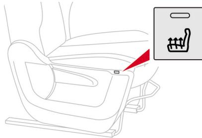
シートヒーターは、外気温が20℃以下で、エンジンが始動している状態のとき作動します。
