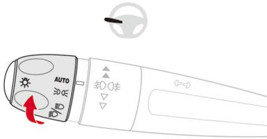
ライトスイッチレバーのリングを回して操作します。
