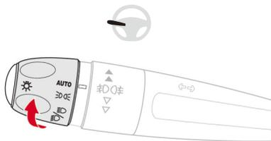
周囲が暗くなったりウィンドウワイパーが作動すると、自動的にポジションランプやヘッドランプが点灯します。周囲が明るくなったりワイパーが停止すると、自動的に消灯します。
