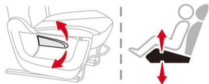
レバーを上下に動かして高さを調整します。
