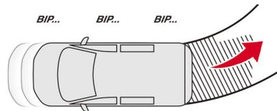
障害物の検知範囲は、ハンドルを切った角度に応じて変化します。例えば、ハンドルを右に切った場合は、障害物の検知範囲が右方向に変化します。
