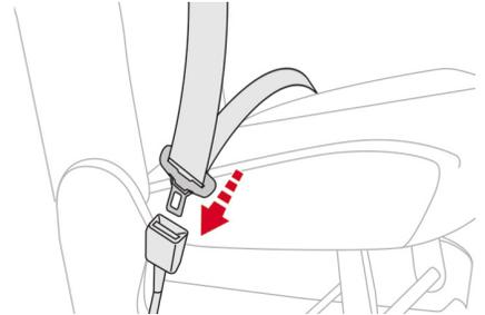
水平方向にあるベルトを、腹部ではなく腰骨に当たるようにしてバックプレートをかちッと音がするまでバックルに差し込みます。バックルの赤いボタンを押すとはずれません。
