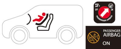
前向きチャイルドシートを助手席に取り付ける際、助手席エアバッグの機能はキャンセルしないでください。
