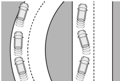
疲労検知システムは、フロントウィンドウのカメラで走行車線の車線マーカを検知し、車両のふらつきから運転者の疲労増加や注意力の低下を判断し、警告音とともにメッセージを表示して運転者に休憩をとるように促します。
