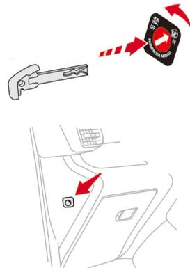
チャイルドシートを後ろ向きに助手席へ取り付けるときは、助手席のエアバッグが作動しないようにします。これはエアバッグが作動してふくらんだときの衝撃からお子さまを守るためです。
