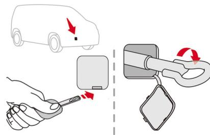
1. カバー下部のすき間に緊急用キーなどを差し込み、回してはずします。緊急用キーなどでボディに傷を付けないように注意してください。
