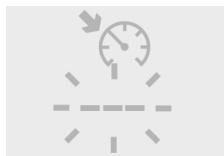
速度表示が消えてーが点滅しているときは、システムに異常があります。シトロエン指定サービス工場で点検を受けてください。
