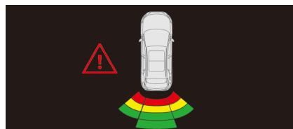
障害物に接近すると警告音の頻度が上がり、およそ30cm以内に接近すると連続した警告音に変わり、危険を表すアイコンが表示されます。
