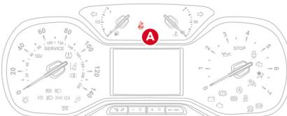
イグニッションがオンのとき、シートベルトを着用していない、または着用していたシートベルトをはずしたときに、インストルメントパネルの警告灯が点灯します。
