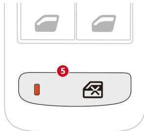
スイッチ⑤を押すと、後席のパワーウィンドウスイッチによる操作ができなくなります。お子さまの危険防止に有効です。スイッチ⑤のインジケーターが点灯している場合は、後席での操作はできません。スイッチ⑤のインジケーターが消灯している場合は、後席での操作は可能です。
