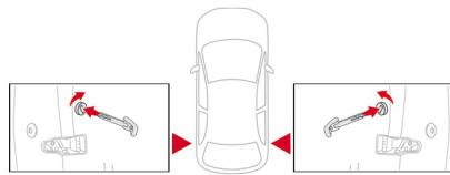
手動チャイルドセーフティを作動させるには、緊急用キーをドアの端部にある赤い穴に差し込み、左側のドアは右方向に、右側のドアは左方向に回します。
