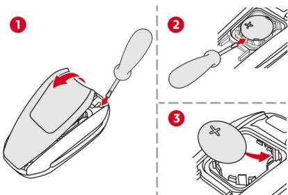
リモコンの電池が消耗すると、メッセージが表示されます。
