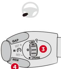
インストルメントパネルに表示された制限速度をアクティブクルーズコントロール（トップ&ゴー機能付き）やスピードリミッターの走行速度に設定することができます。
