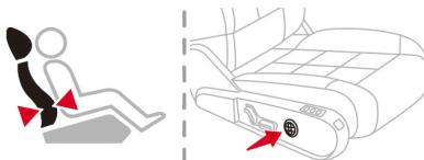
スイッチの前後を押してランバーサポートの張り出しを調整します。
