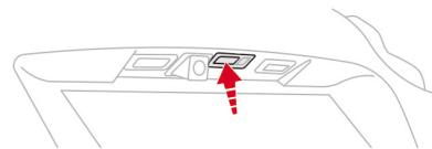
車両周辺の検知エリアにスマートキーがあるときに、テールゲートのスイッチ左側を押します。すべてのドアおよびテールゲートが解錠され、テールゲートが少し開きます。
