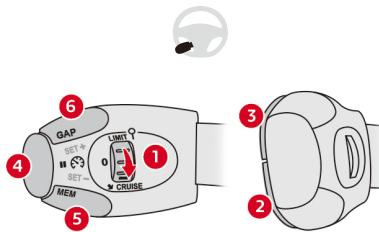
アクティブクルーズコントロールは、コントロールレバーのスイッチを使用して設定します。
