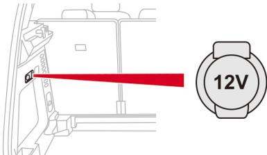
12V 電源（最大使用電力：120W）を使用する際は、カバーを持ち上げてはずし、適切なアダプターを接続します。
