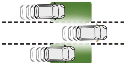
ブライアンドスポットモニターは、ドアミラーでの確認が困難な範囲に他車が進入した際に、その存在を検知して運転者に警告するシステムです。
