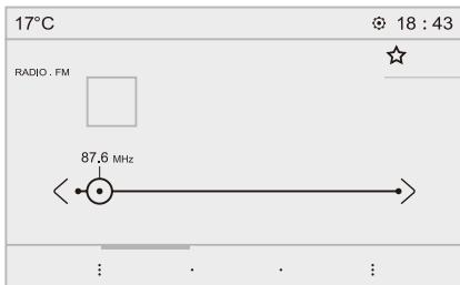
タッチスクリーンのカーソルを左右に動かすと受信周波数が変わります。またはカーソルの上の現在受信している放送局周波数にタッチし、タッチスクリーンから周波数を入力して OK にタッチします。
