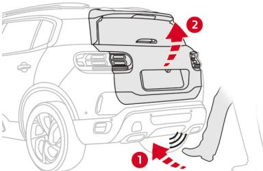
ハンズフリー機能は、車両後方の検知エリアにスマートキーがあるときに、リアバンパーの下部で、ナンバープレートの横幅の範囲にある検知エリアに足を蹴り出することで①、テールゲートの開閉、または停止を行うことができます②。
