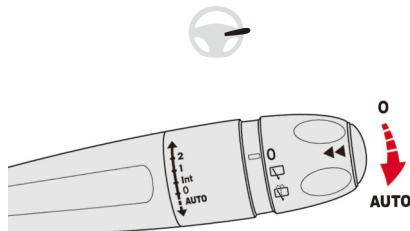
レバーを押し下げる AUTO モードが作動します。インストルメントパネルの表示灯が点灯し、メッセージが表示されます。
