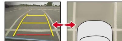
フロントバンパーに埋め込まれたセンサーが周囲の状況を検知し、自動でスタンダードとズームビューを切り替えます。
