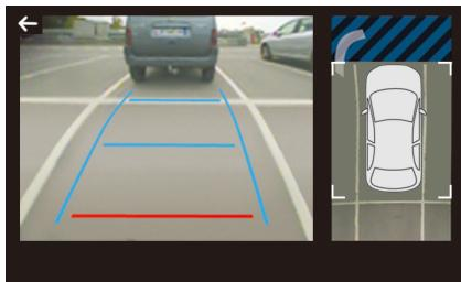
フロントグリルのカメラ\*、テールゲートのカメラ、およびフロント／リアバンパーに埋め込まれたセンサーがタッチスクリーンに車両周囲の映像を映し出し、駐車や出庫の際の安全確認を補助します。
