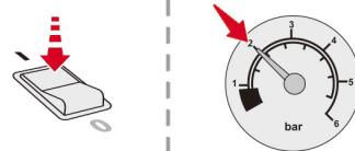
9. スイッチをOFFにしてから、パンク修理キットを取りはずし、直ちに走行してタイヤ内に修理剤を行き渡らせます。このとき、時速20～60kmで約5km走行します。
