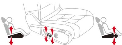
・ 高さ：スイッチの後端を上下して調整します。
