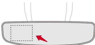
バックミラーの左部分には液晶ディスプレイが内蔵されていて、サイドビューカメラの映像を表示するカメラモニターとなっています。
