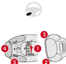
スピードリミッターは、コントロールレバーのスイッチを使用して設定します。
