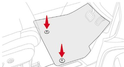
取り付けるときは、フロアマットを正しい位置に合わせ、クリップで留めてください。フロアマットがしっかりと固定されていることを確認してください。
