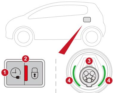
リチウムイオンバッテリーを充電するときは、普通充電ポート③に充電コネクターを接続します。充電が開始されると充電インジケーター④が緑色に点滅します。また、充電コネクターがロックされ、充電コネクターロック表示灯②が赤色に点灯します。
