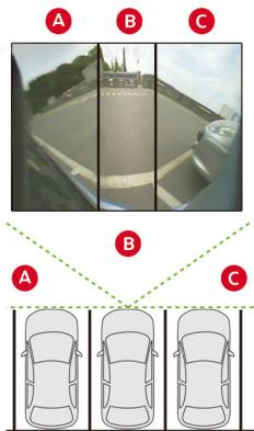
垂直駐車から前進して出るときに、左右から近付く車、自転車や歩行者の映像を左方向 A、前方 B、右方向 C に分けて映し出します。
