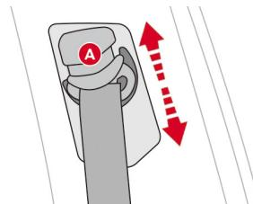
ベルトを引き出し、アンカー **A** の中央部を押しながらアンカー **A** を上下にスライドさせて、ベルトが肩先と首との間に当たるよう合わせます。
