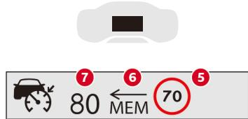
3. トラフィックサインインフォメーションが速度規制標識を認識し、制限速度⑤を表示したら、MEM ⑥が点滅します。
