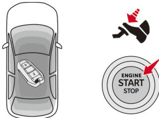
スマートキーが車内の検知エリアにあるときに、ハイブリッドシステムを始動および停止することができます。
