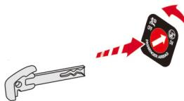
チャイルドシートを進行方向とは逆向きに助手席へ取り付けるときは、助手席のエアバッグが作動しないようにします。これはエアバッグが作動してふくらんだときの衝撃からお子さまを守るためにです。
