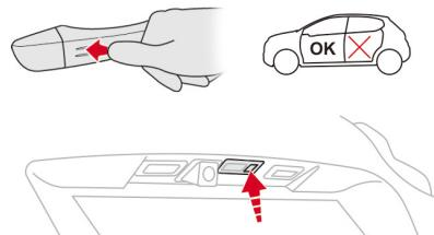
車両周辺の検知エリアにスマートキーがあるときに、前席のドアハンドルのスイッチまたはテールゲートのスイッチ右側を押します。すべてのドアおよびテールゲートが施錠されます。
