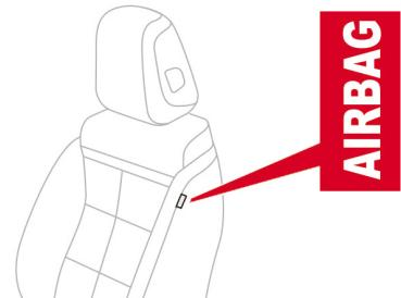
運転席および助手席のバックレスト側面（ドア側）に収納されており横からの衝撃に対してのみ、左右が独立して展開します。
