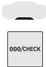
トリップメーターをリセットするには、**ENGINE START/STOP**スイッチがアクセサリー位置のとき、またはハイブリッドシステムが始動している状態のときに、インストルメントパネルのリセットボタンを数秒間押し続けます。数値が0になったらリセットボタンを放してください。
