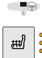
シートヒーターは運転席と助手席に装備され、ハイブリッドシステムが始動している状態のとき、別々に作動させることができます。
