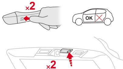
車両周辺の検知エリアにスマートキーがあるときに、前席のドアハンドルのスイッチまたはテールゲートのスイッチ右側を押します。5秒以内に再度スイッチを押します。
