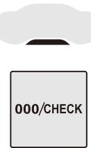
インストルメントパネルのリセットボタンを押すと、サービスインジケーターを数秒間表示させることができます。
