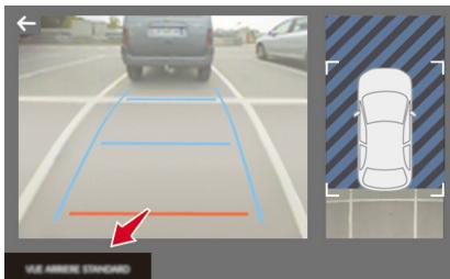
フロント \* / バックビューは、フロントグリルのカメラ \*、テールゲートのカメラが車両前方または後方の映像を映し出します。オートモードで作動し、フロント／リアバンパーに埋め込まれたセンサーが周囲の状況を検知し、自動でスタンダードとズームビューを切り替えます。
