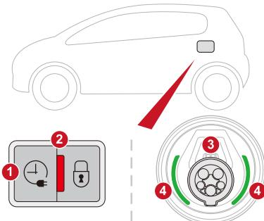
リチウムイオンバッテリーを充電するときは、車載充電ケーブルの充電コネクター、または充電器に付属の充電ケーブルの充電コネクターを車両の普通充電ポートに接続します。
