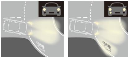
ヘッドライトに加えてフォグランプがカーブの内側を照らし、交差点や曲がりくねった道、駐車操作中に障害物を発見しやすくする機能です。時速40km以下で走行中に作動します。
