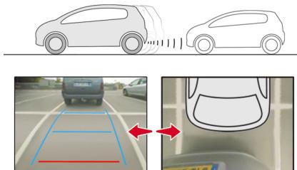
リアバンパーに埋め込まれたセンサーが周囲の状況を検知し、障害物が赤いライン（リアバンパーの後方約30cm）に近付くと自動でスタンダードからズームビューに切り替えます。
