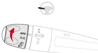
周囲が暗くなったりウィンドウワイパーが作動すると、自動的にポジションランプやヘッドライトが点灯します。周囲が明るくなったりワイパーが停止すると、自動的に消灯します。
