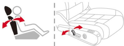
スイッチを前後に倒して背もたれの角度を調整します。
