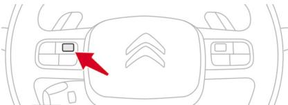
ステアリングスイッチのダイヤルを回すとインストルメントパネルの表示モードが切り替わります。
