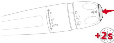
トリップ1／トリップ2をリセットするときは、ワイパーレバー先端のスイッチを2秒以上押し続けます。リセットは各トリップごとに行うことができます。リセット後しばらくはデータ不足のために正確な値が表示されないことがあります。
