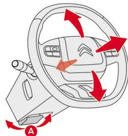
1. ロックレバー A を手前に引き、ステアリングのロックを解除します。
