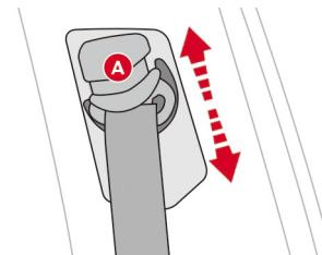
ベルトを引き出し、アンカーAの中央部を押しながらアンカーAを上下にスライドさせて、ベルトが肩先と首との間に当たるように合わせます。
