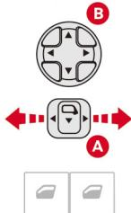
調整するミラーに合わせて、スイッチ A を左側または右側に動かします。
