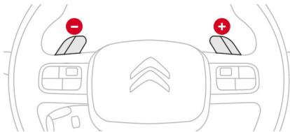
ステアリングの裏側にパドルスイッチがあります。シフトポジションが **D** または **B** でガソリンエンジンが始動している状態のとき、パドルスイッチの操作で一時的に手動でギアを切り替えることができます。右側 (+) のスイッチでシフトアップ、左側 (-) のスイッチでシフトダウンします。アクセルペダルを踏み込んだまま操作することができます。
