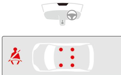
インストルメントパネルとシートベルト着用／非着用ディスプレイのシートベルト警告灯および該当する座席位置の警告灯が点灯または点滅して、シートベルトの着用状況を表示します。
