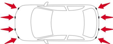
フロント／リアバンパーに埋め込まれたセンサーが障害物（歩行者、車、立木、門など）を検知します。
