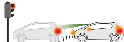
ディスタンスアラートの警告が表示された後も運転者が衝突回避動作を取らなかったとき、自動ブレーキが作動し、衝突回避を支援したり、衝突時の速度を低減します。
