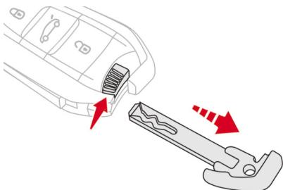
以下のようにスマートキーの機能が使用できないときは、運転席ドアの鍵穴に緊急用キーを差し込んで施錠／解錠します。
