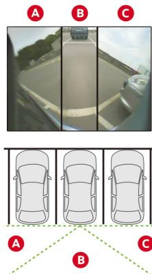
垂直駐車から後退して出るときに、左右から近付く車、自転車や歩行者の映像を左方向 A、後方 B、右方向 C に分けて映し出します。
