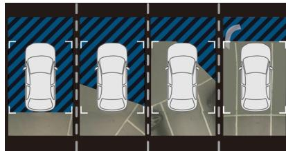
パノラミックビューは、フロントグリルのカメラ\*およびテールゲートのカメラの映像を合成して表示します。駐車や出庫の際に、車両周辺の障害物を確認できます。
