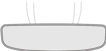
センサーで周囲の明るさやミラーにあたる光を感じし、昼と夜で自動的にミラーの明るさを調整します。また、夜間に後続車のヘッドライトがミラーに反射した場合も、自動的に暗くなって後方の視界を確保します。
