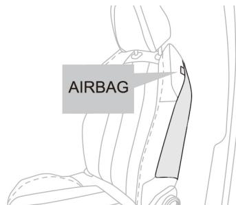
運転席および助手席のバックレスト側面（ドア側）に収納されており横からの衝撃に対してのみ、左右が独立して展開します。
