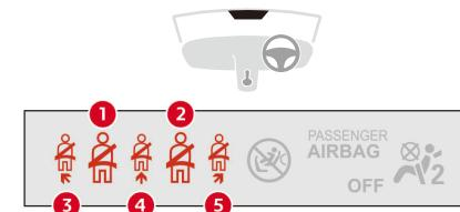
インストルメントパネルとシートベルト着用/非着用ディスプレイの警告灯が点灯または点滅して、シートベルトの着用状況を表示します。
