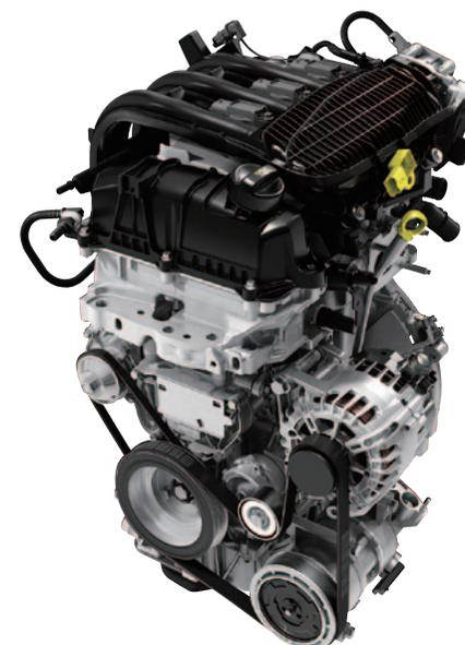
の点火調整 (IGR) を採用することで、燃焼効率を最適化しました。アルミニウム合金製のシリンダーヘッドには、気筒あたり4本のバルブを配置し、マルチポイント方式およびインテーク/エキゾーストの両側に無段階可変バルブタイミング (VVT) を採用し、高効率化を図っています。
