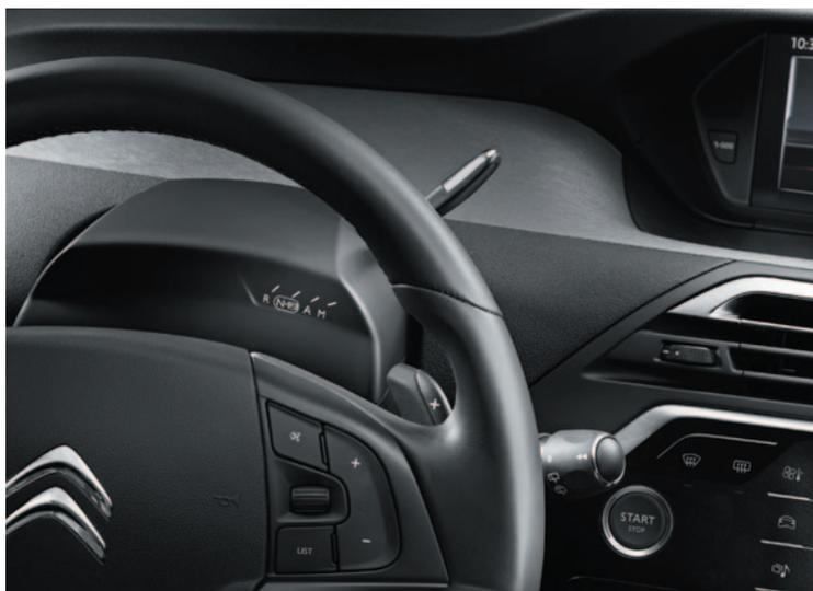
ETG 5 (Efficient Tronic Gearbox 5:エフィシヤント・トロニック・ギアボックス 5) は、PSAプジョー・シトロエン・グループが新たに開発、製造する次世代型のトランスミッションです。オートマチックモードと、パドルシフトによるマニュアルモードによってリニアなレスポンスとダイレクトな走行感覚を生み出します。また、スムーズなギアシフトプログラムと操作性に優れたクリープ機構など扱いやすい機能も持ち合わせています。
