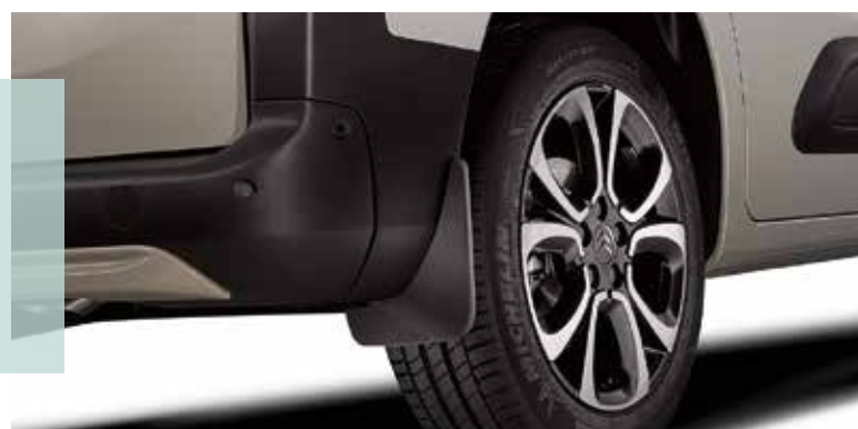
■ マッドガードリア タイヤが跳ね上げる砂利などからボディを守り、泥汚れの防止にも効果的です。
