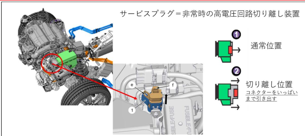
事故などの緊急事態が生じた場合、用意されたサービスプラグを操作することで高電圧回路を切り離すことができます。
