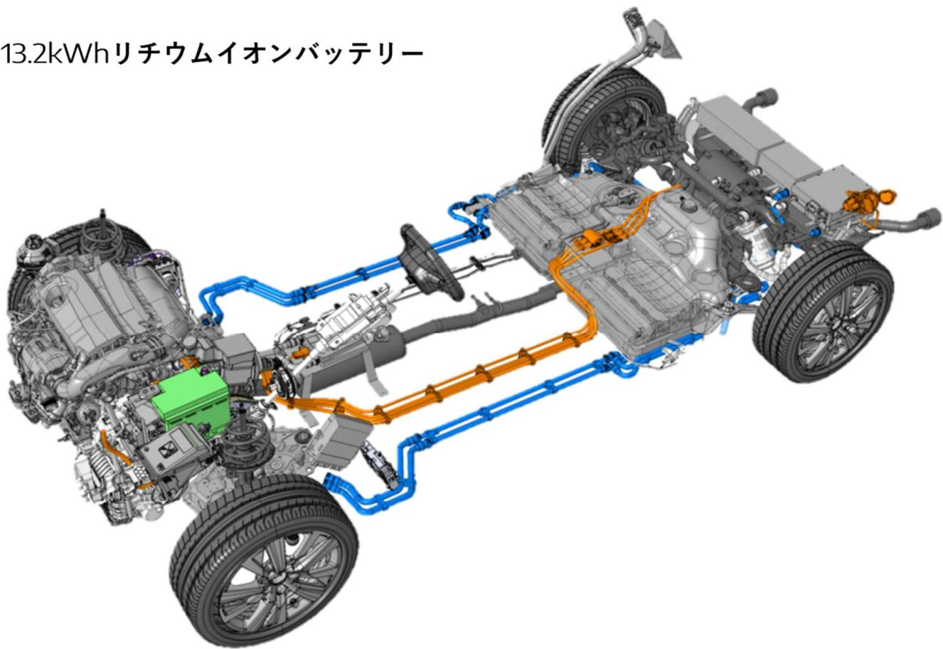
車両の高電圧ケーブルは、被覆をオレンジ色で統一しています。
